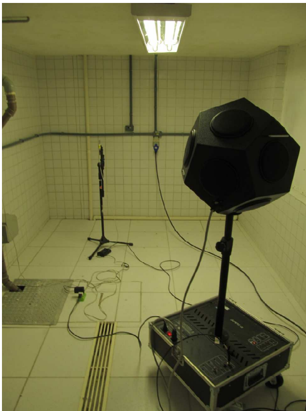
Figura 16. Equipamentos montados para medições das funções de transferência em pontos da sala receptora para medição do tempo de reverberação.
