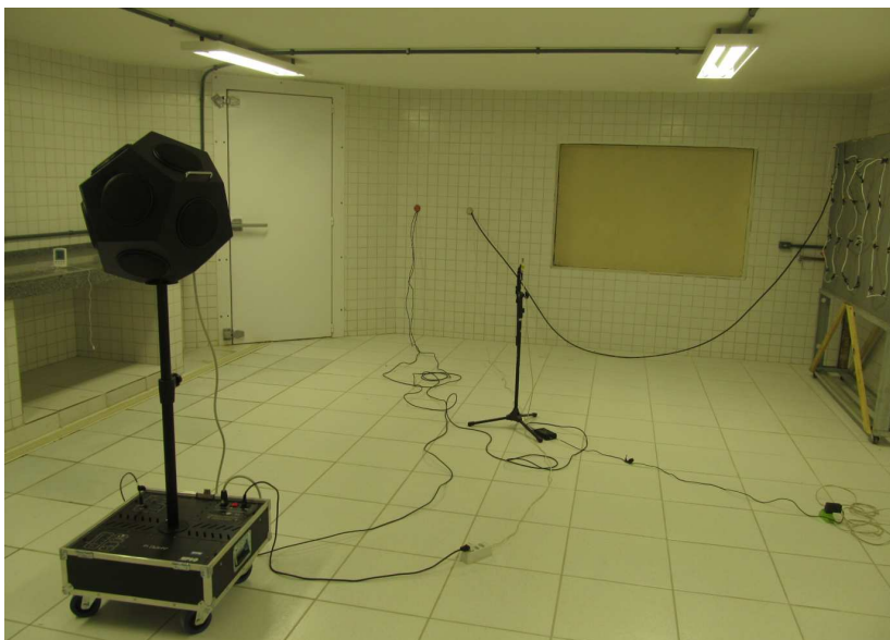
Figura 14. Equipamentos montados para medições das funções de transferência entre pontos da sala emissora.
