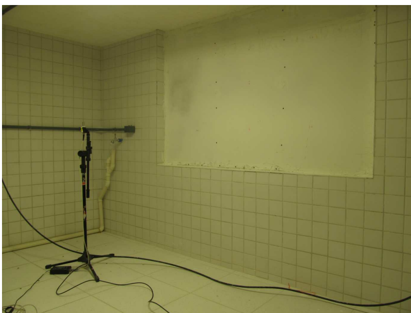
Figura 15. Equipamentos montados na sala receptora para medições das funções de transferência entre a sala emissora e receptora.
