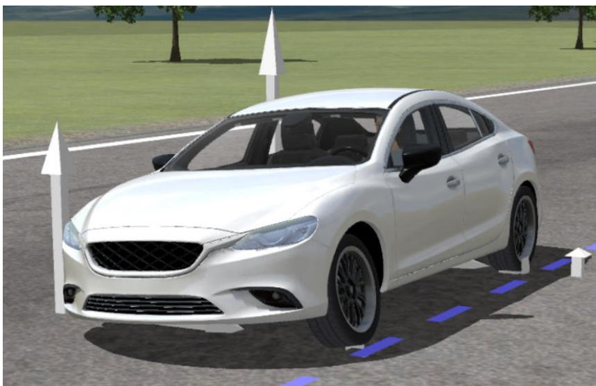
Figura 44 - Perda de contato da roda dianteira esquerda com o solo, indicada pelo desaparecimento do vetor de força normal
