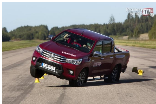
Figura 18 – Exemplo de um caso de risco de capotamento durante o "teste do alce".
