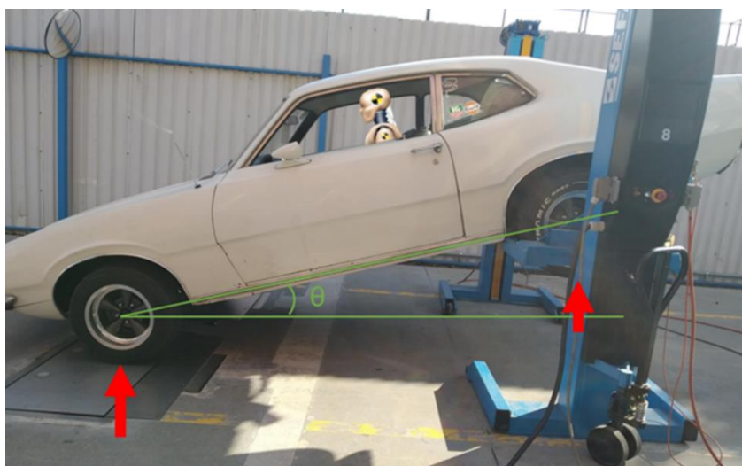
Figura 25 – Medição de massa com o veículo inclinado. \theta = 13,62^\circ
