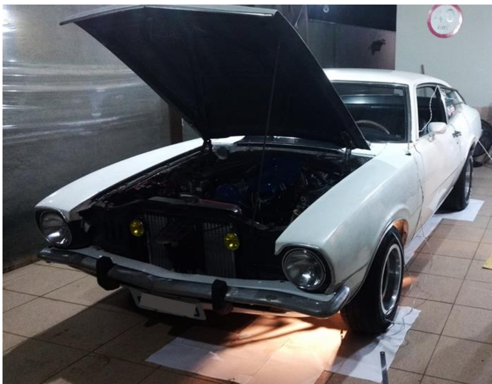
Figura 27: Plano milimetrado construído abaixo do veículo
