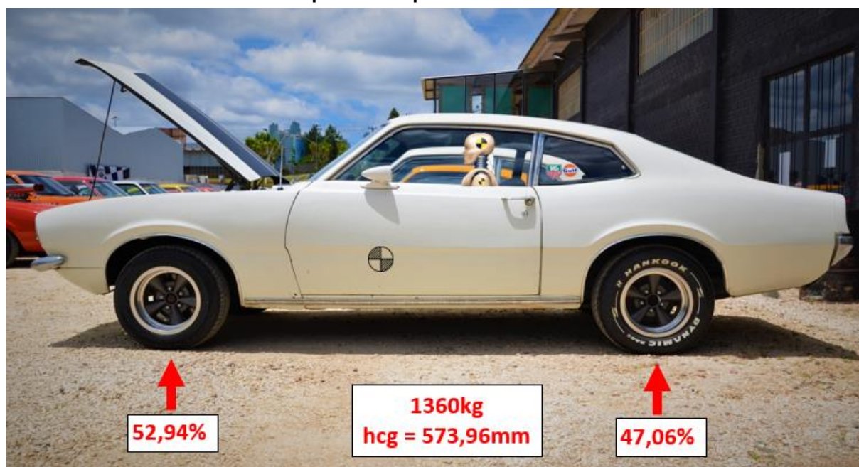
Figura 26: Localização do CG em relação ao veículo no plano XZ e distribuição de massa percentual por eixo.
