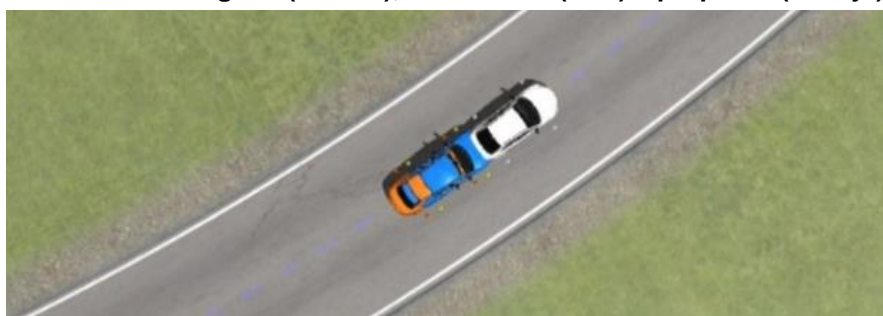
Figura 51 - Comparativo de distância de parada após o teste de frenagem. Veículo original (branco), benchmark (azul) e proposto (laranjo)
