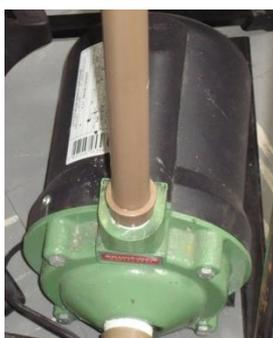
**Figura 4.5.** Bomba centrífuga utilizada no experimento.
