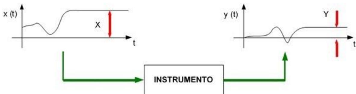
**Figura 2.7.** Representação do processo de monitoramento dos sinais para obtenção dos valores em regime permanente na entrada ( $X$ ) e na saída ( $Y$ ) do instrumento.
