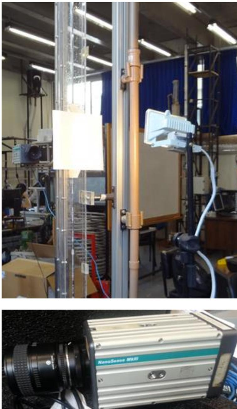
**Figura 4.27. Sistema de filmagem e aquisição de quadros de imagem.**
