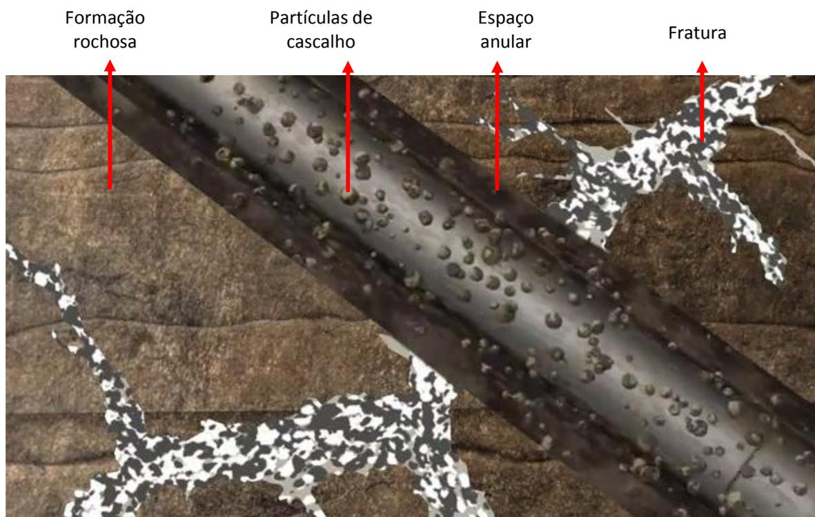
**Figura 1.3. Operação de perfuração de poço com geração de partículas de cascalho e presença de fissura na formação rochosa.**
