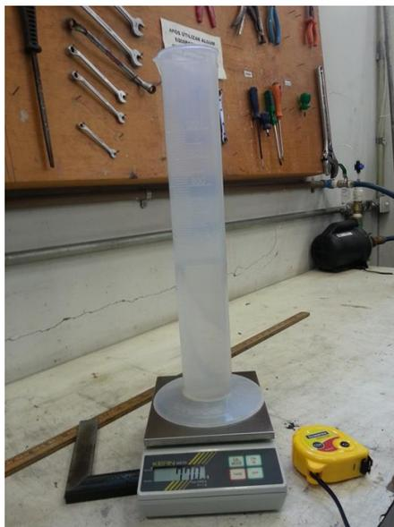
**Figura 4.23. Detalhe de equipamentos auxiliares ao ensaio de calibração do medidor de vazão.**
