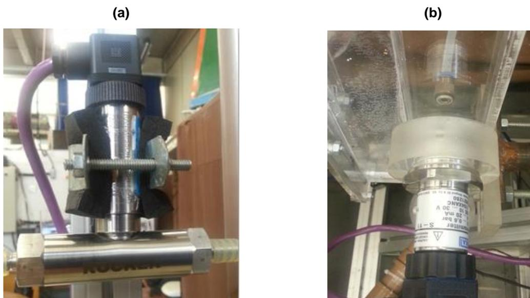
Figura 4.11. Transdutor de pressão diferencial e detalhe dos pontos de tomada de pressão.
