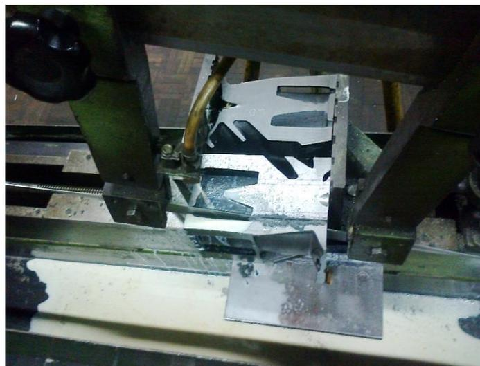
Figura 3.4: Corte dos corpos de prova axiais
