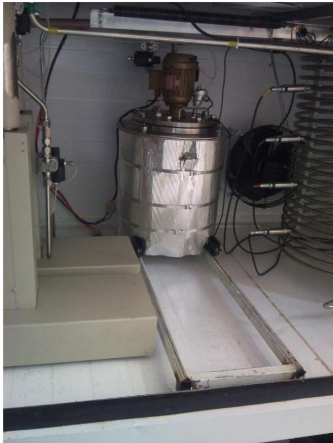
**Figura 4.2 - Reservatório térmico sobre trilho**
