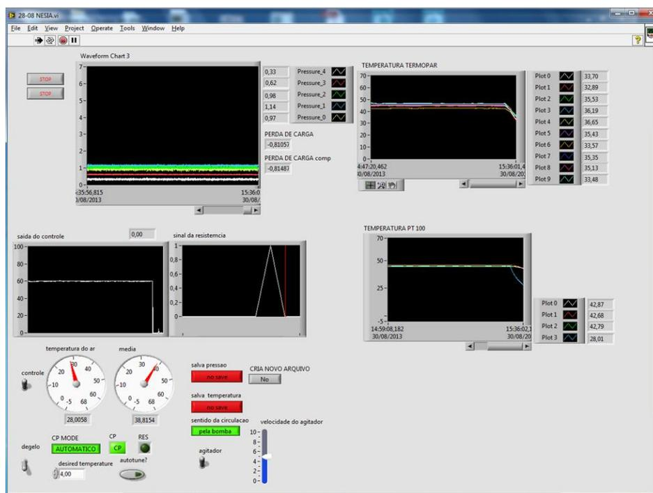
**Figura 4.15 - Janela de monitoramento do LabVIEW da bancada**
