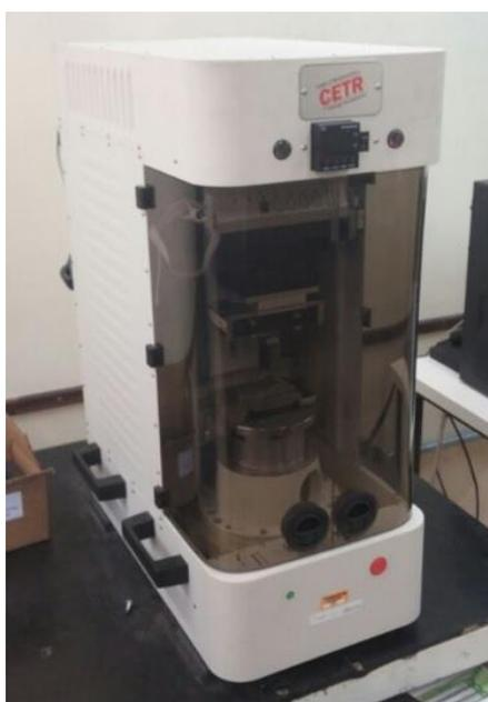
Figura 3-4 – Tribômetro utilizado para a realização dos ensaios.
