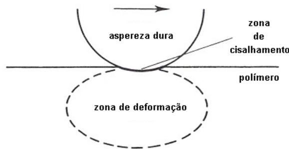
**Figura 2-4 – Delimitação das zonas de cisalhamento e deformação a partir do deslizamento da aspereza dura contra o polímero.**
