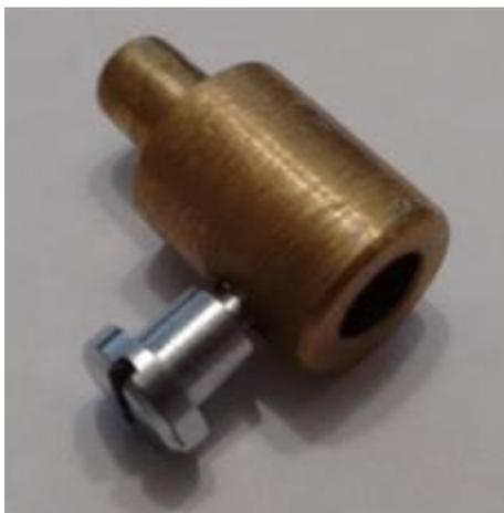
Figura 3-5 – Porta-amostras para fixação dos corpos de prova.
