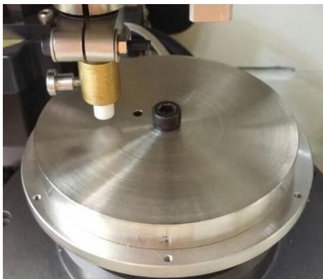
**Figura 3-7 – Configuração típica do par tribológico antes dos ensaios.**
