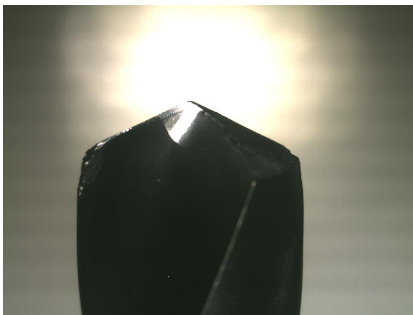
Figura 4.8 – Imagem lateral do desgaste da aresta de corte da broca helicoidal com revestimento Alcron a uma vida de 3200 peças usinadas.
