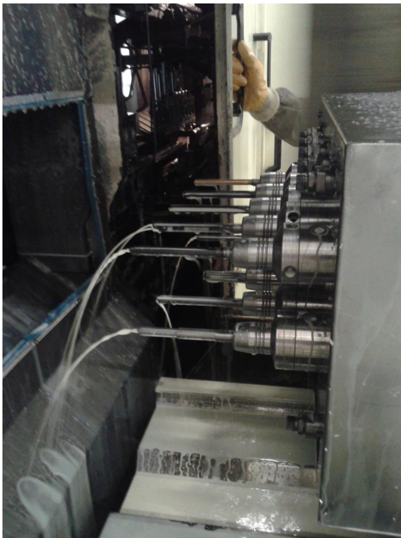
Figura 3.3 – Cabeçote de furação utilizado na usinagem dos furos de junção do cabeçote com o bloco.
