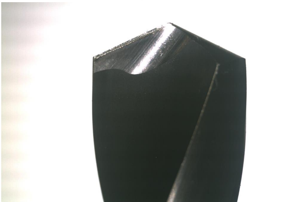
Figura 4.11 - Imagem superior do desgaste das arestas de corte da broca helicoidal com revestimento Firex a uma vida de 5000 peças usinadas.
