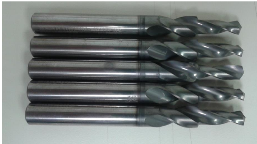
Figura 3.7 – Brocas helicoidais com revestimento Alcrona.
