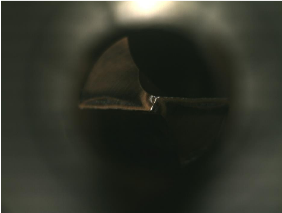
Figura 4.9 - Imagem superior do desgaste das arestas de corte da broca helicoidal com revestimento Pertura a uma vida de 4950 peças usinadas.
