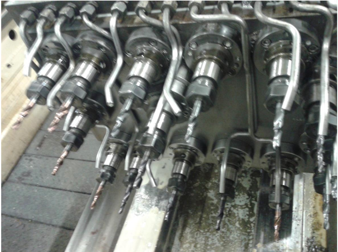
Figura 3.6 - Cabeçote de furação utilizado na usinagem dos furos de junção do bloco com o cárter.
