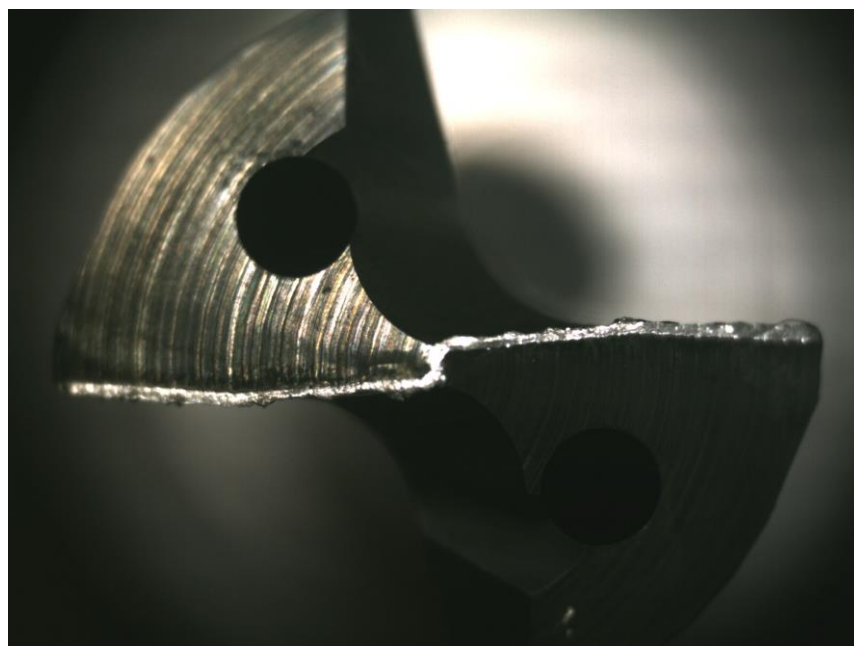
Figura 4.3 Imagem superior do desgaste das arestas de corte da broca sem revestimento à uma vida de 13000 peças usinadas.
