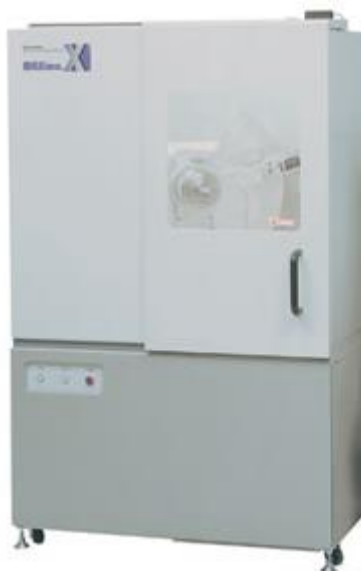
Figura 15 - Difratômetro Shimadzu XRD 7000
