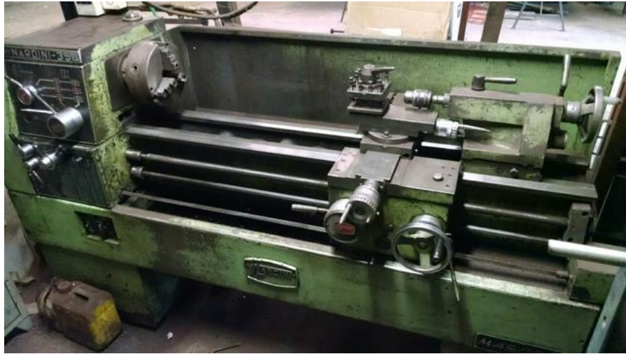
Figura 16 - Torno mecânico (Marca: Nardini; Modelo: Mascote 350)
