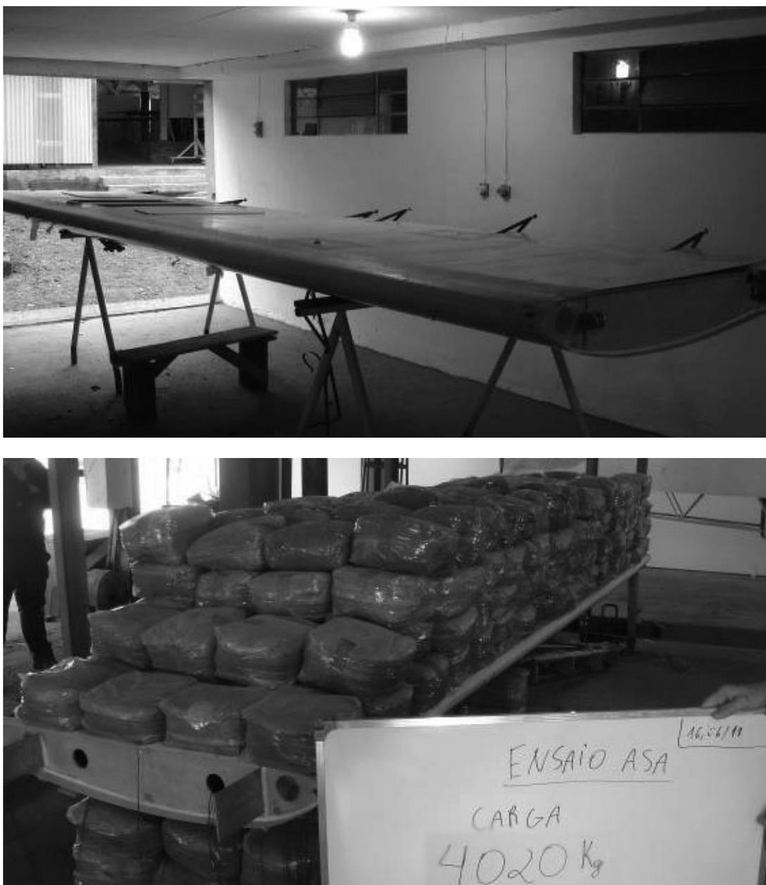
**Figura 3.36:** Tipo de estrutura proposta para asa. (a) Estrutura construída em fibra de vidro, espuma PET e bordos de alumínio com objetivo de teste da técnica; (b) estrutura em ensaio de flexão em 4 pontos.
