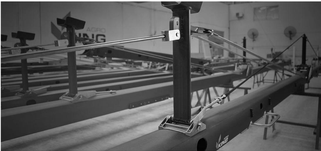
**Figura 2.29:** Barras de pulverização terrestre em material composto (GOOGLE-IMAGES, 2014)
