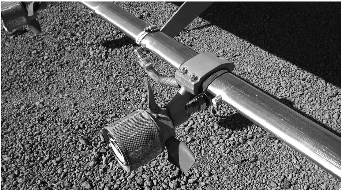
**Figura 2.22:** Atomizador rotativo
