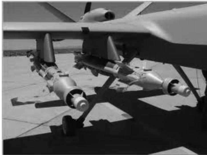
**Figura 2.11:** Carga paga do VANT de combate (Reaper)
