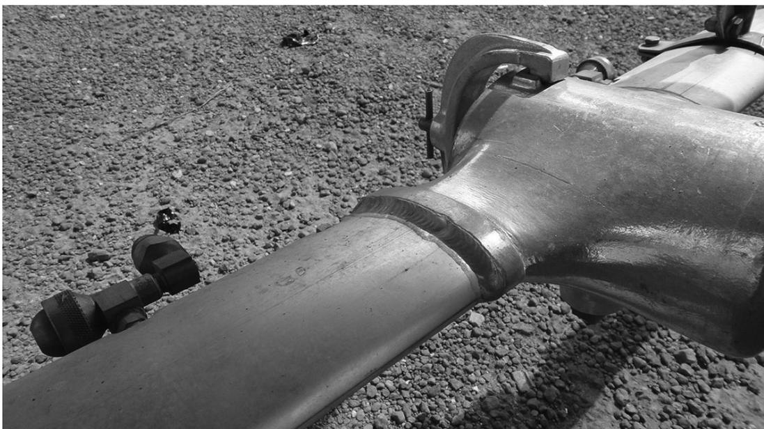
**Figura 2.21:** Barras de pulverização aérea de aço inox
