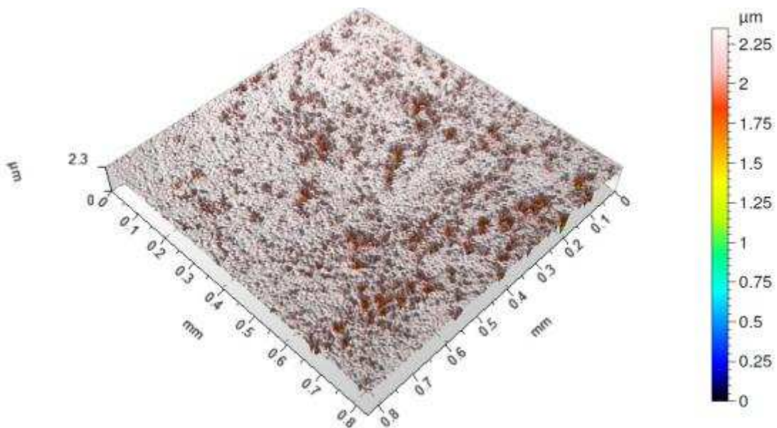
Figura 122 – Imagem topográfica da Região 2 da amostra revenida a 300°C por 3 horas, após ensaio eletroquímico em meio NaCl 0,5 mol/dm 3 .
