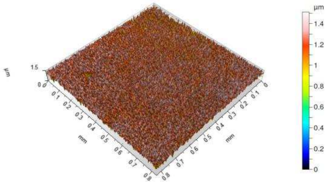
Figura 171 – Imagem topográfica da Região 1 da amostra revenida a 600°C por 2 horas, após ensaio eletroquímico em meio NaCl 0,5 mol/dm 3 .
