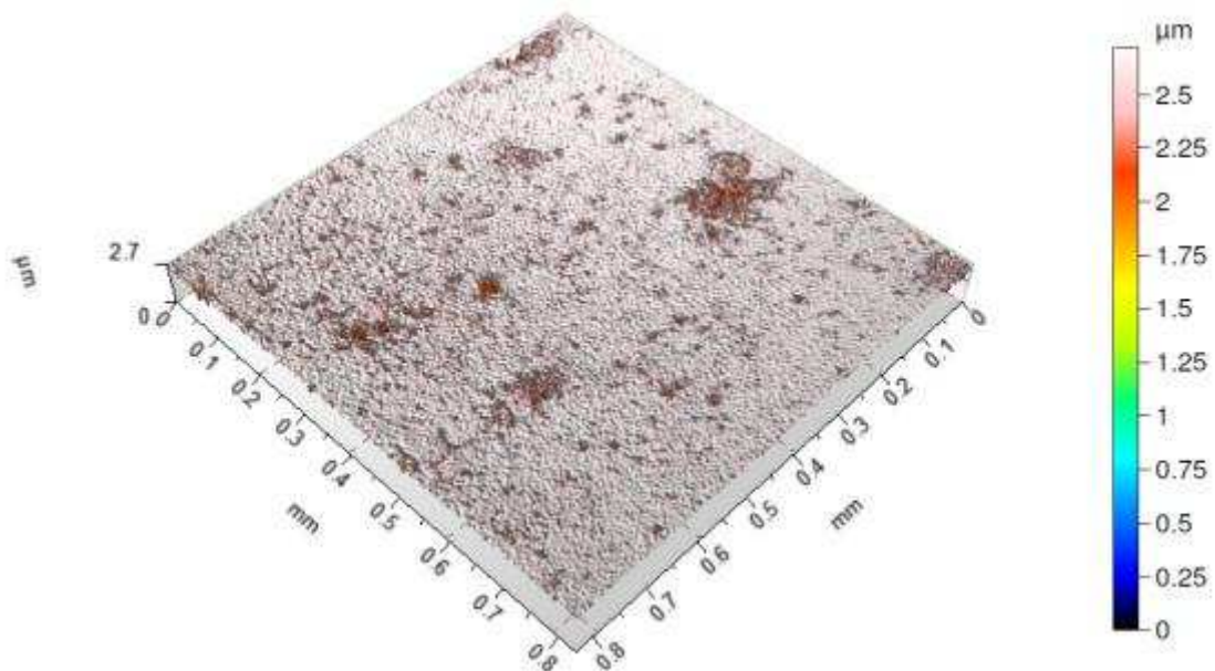
Figura 114 – Imagem topográfica da Região 4 da amostra revenida a 300°C por 2 horas, após ensaio eletroquímico em meio NaCl 0,5 mol/dm 3 .
