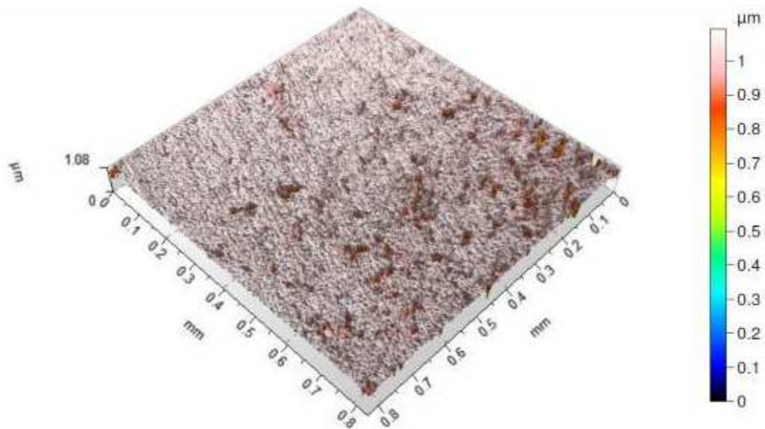
Figura 126 – Imagem topográfica da Região 6 da amostra revenida a 300°C por 3 horas, após ensaio eletroquímico em meio NaCl 0,5 mol/dm 3 .
