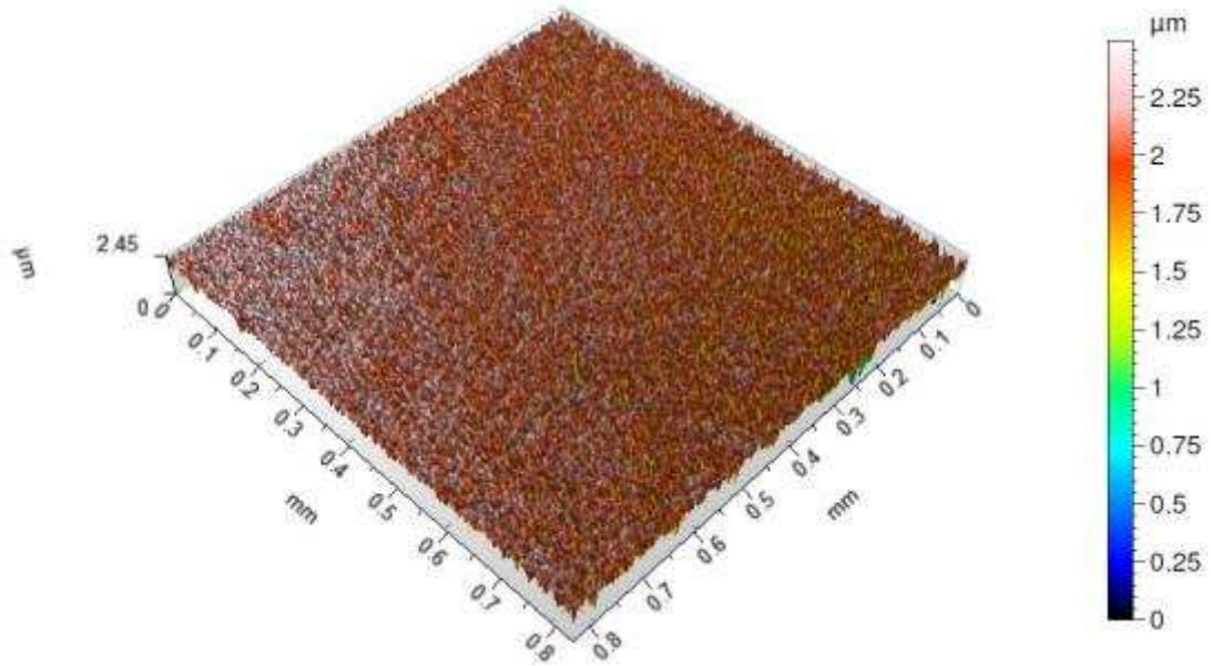
Figura 177 – Imagem topográfica da Região 7 da amostra revenida a 600^{\circ}\text{C} por 2 horas, após ensaio eletroquímico em meio \text{NaCl} 0,5 \text{ mol/dm}^3 .
