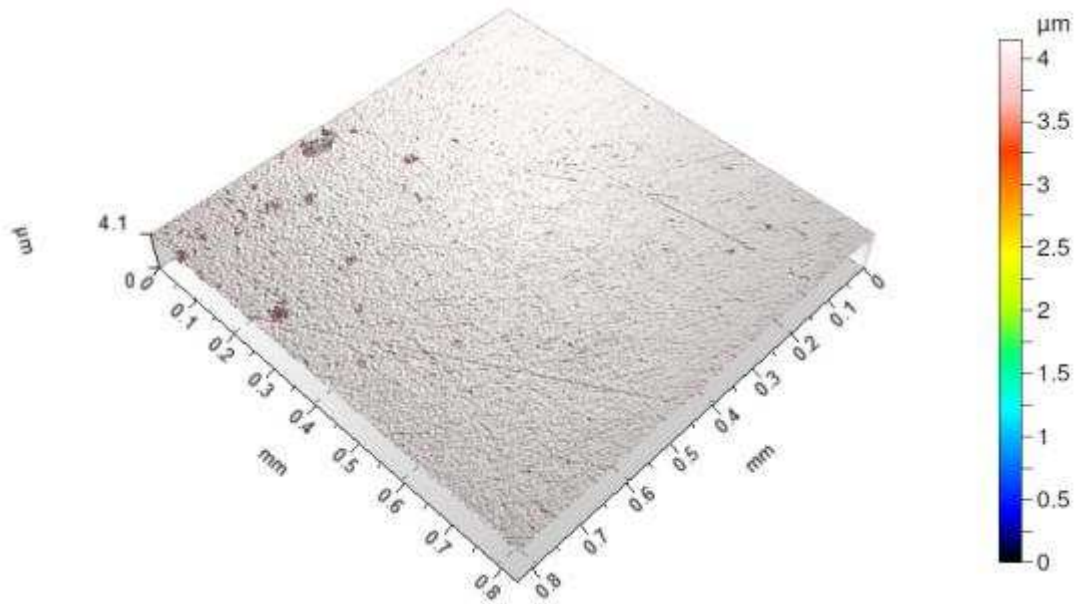
Figura 97 – Imagem topográfica da Região 7 da amostra do aço AISI 420 temperado a 1000°C por 20 minutos, após ensaio eletroquímico em meio NaCl 0,5 mol/dm 3 .
