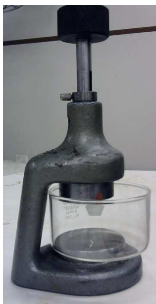
Figura 15 – Pressionadora de amostras e recipiente de vidro. Auxiliares na técnica do menisco.
