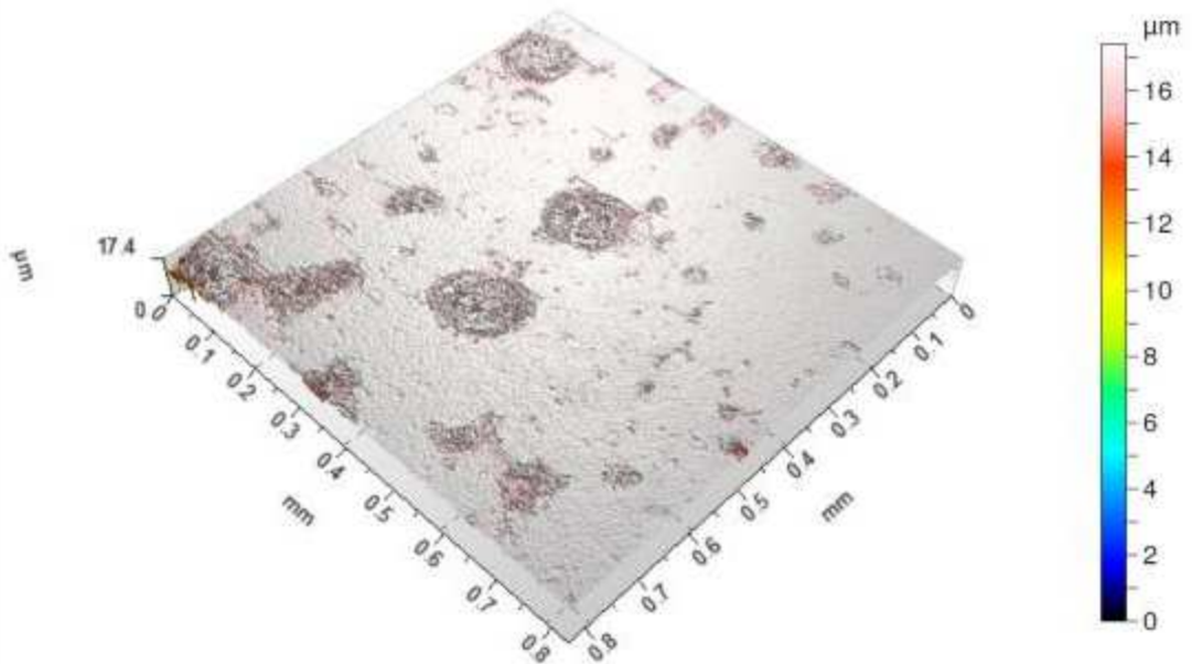
Figura 96 – Imagem topográfica da Região 6 da amostra do aço AISI 420 temperado a 1000°C por 20 minutos, após ensaio eletroquímico em meio NaCl 0,5 mol/dm 3 .
