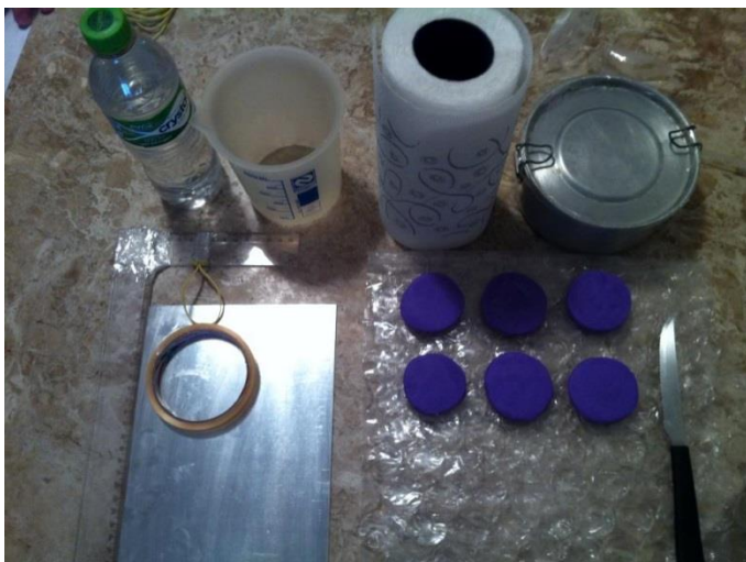
Figura 24 - Materiais utilizados no teste de efetividade da água como desmoldante
