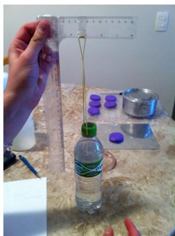
a) Parametrização do coeficiente da mola utilizando uma massa conhecida
