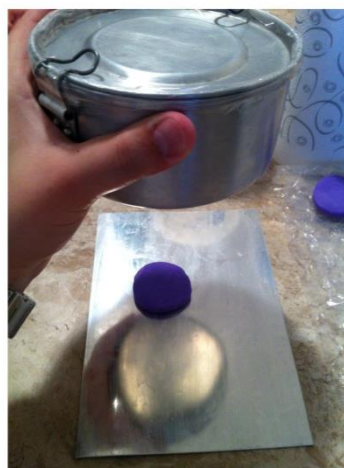
b) Peso padrão é solto para criar adesividade igual para todos os corpos de prova
