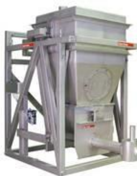
Figura 9 - Dosador gravimétrico Loss-in-Weight Gericke Fonte: Gericke, (2013)
