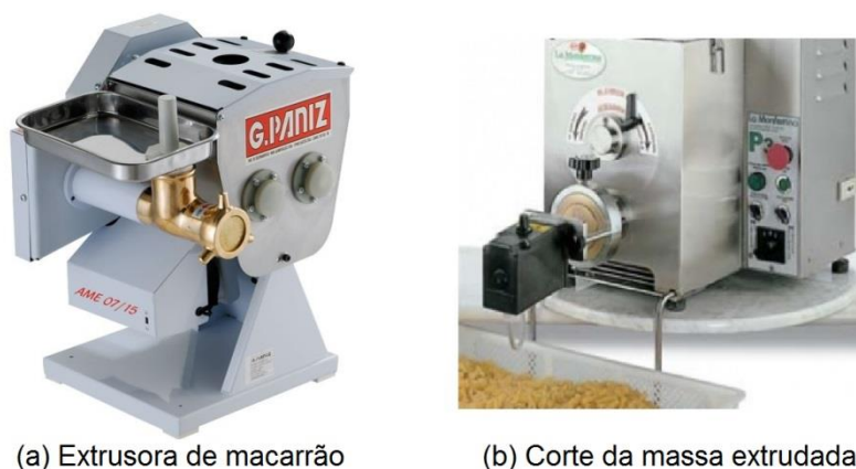
Figura 12 – Sistema de extrusão de macarrão
