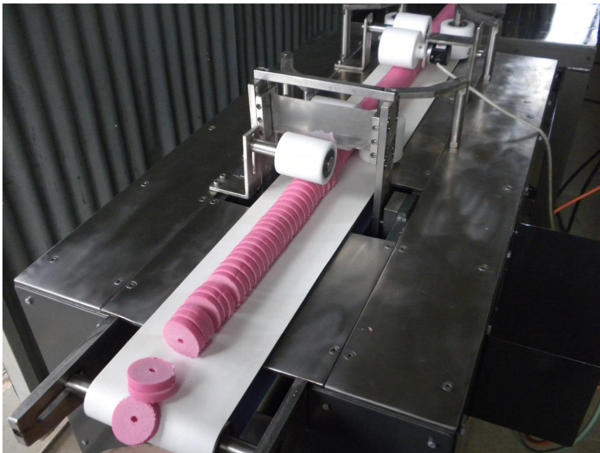
Figura 37 – Pastilhas de PRATIC sendo seccionadas pelo protótipo
