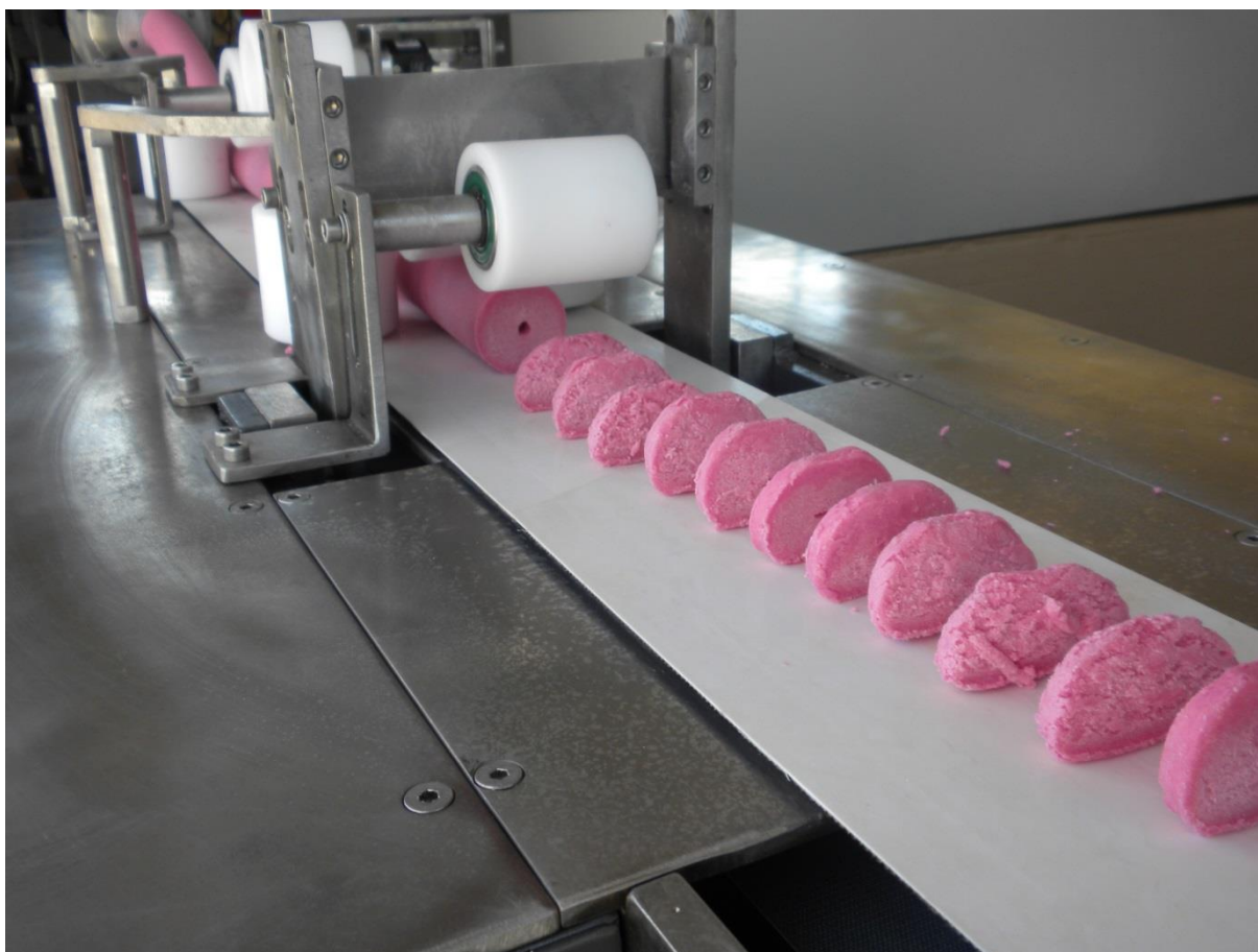
Figura 38 – Corte da massa mole, prejudicado pela aderência com o equipamento
