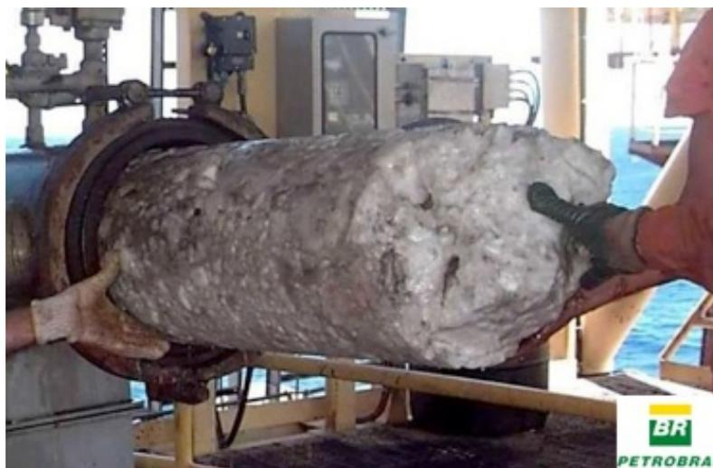
**Figura 3: Obstrução (plug) formada por hidrato em tubulação.**
