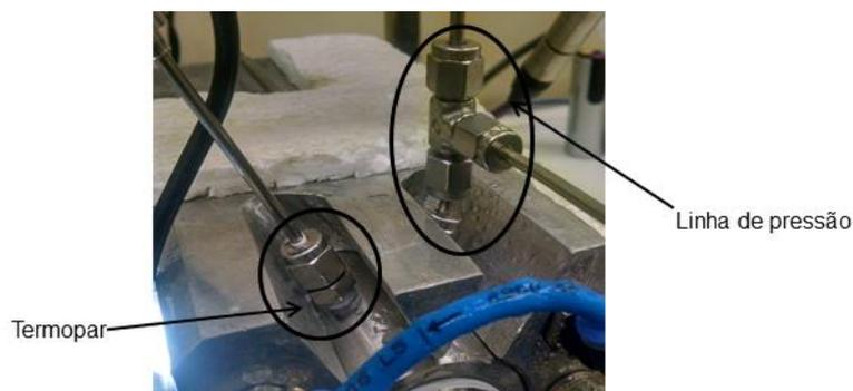
**Figura 28 – Conexões termopar e linhas de gás**
