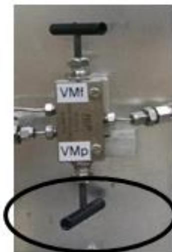
**Figura 41 – Válvula de purga do sistema**
