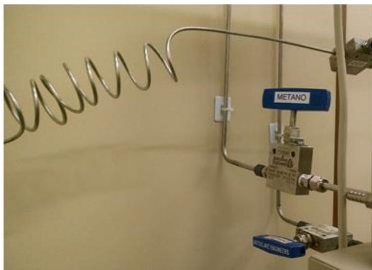
Figura 38 – Linha de circulação de gás do cilindro para a bomba
