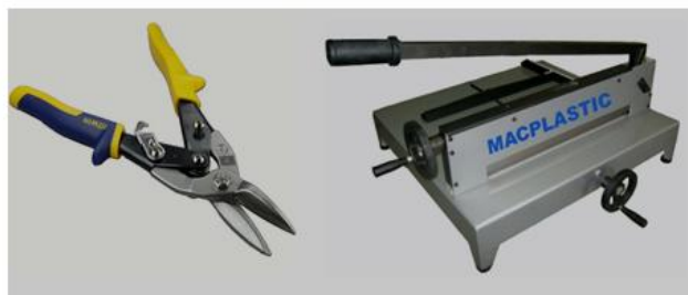
Figura 13 – Exemplos de Corte por Cisalhamento http://www.artesana.com.br/
