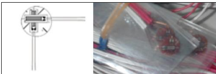
Figura 24 - Extensômetros utilizados na Aquisição Experimental
