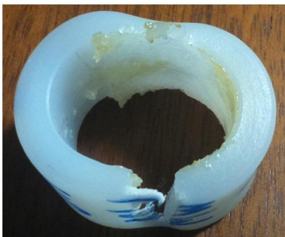
**Figura 4.5 - Desgaste excessivo PEUAPM após 90 minutos de ensaio**
