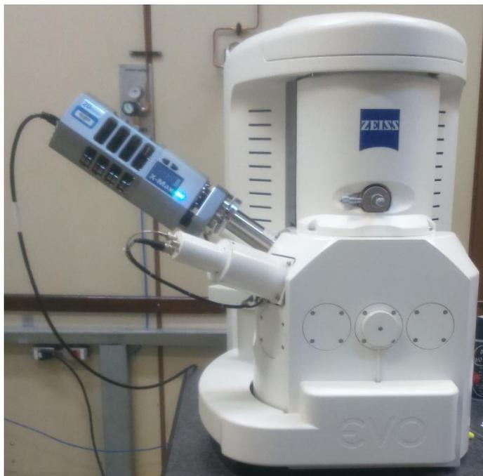
**Figura 3.8 - Microscópio Eletrônico de Varredura**
