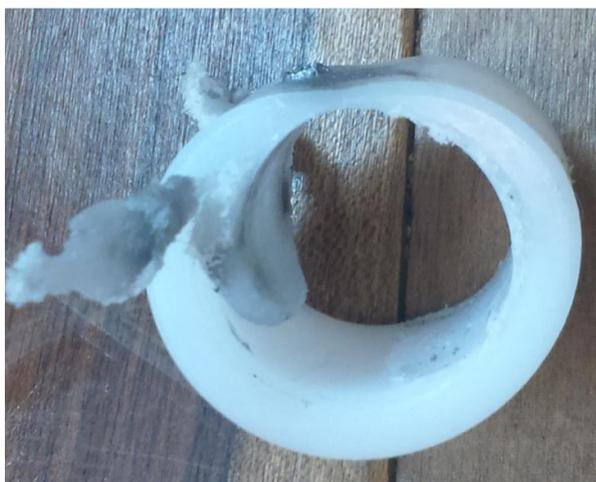
**Figura 4.4 - Desgaste excessivo PEAD após 20 minutos de ensaio**
