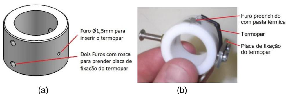
**Figura 3.13 - Detalhes do corpo com adaptação do termopar para medição da temperatura no contato: (a) vista em perspectiva com detalhes acrescidos (b) fotografia da montagem do termopar no corpo.**
