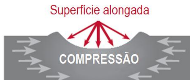
Figura 5 - Campo de tensão residual compressiva gerada pela deformação do jateamento.
