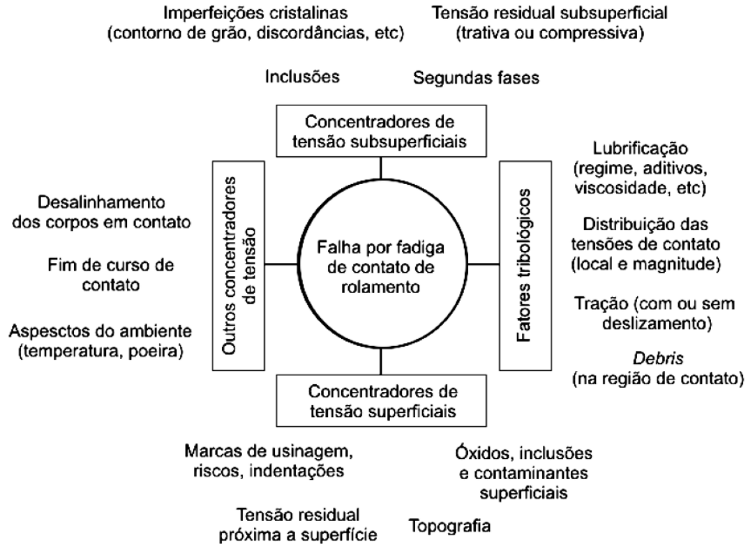
Figura 24 - Fatores que influenciam a vida em fadiga de contato de rolamento.
