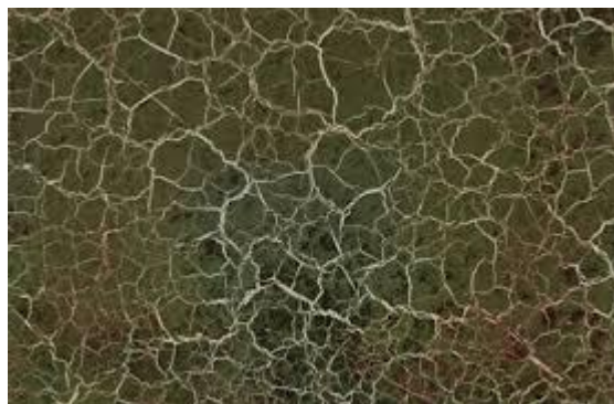
Figura 7 - Microfissuras na superfície do metal duro (Figuras Craquelet)
