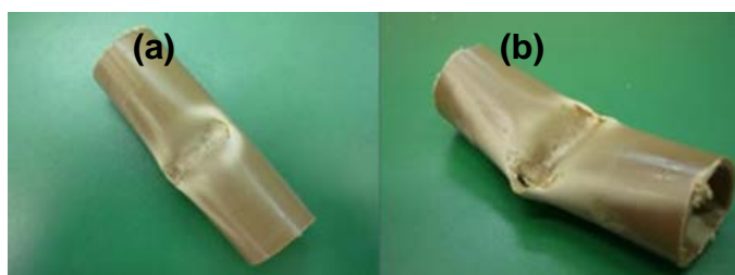
Figura 29 - corpos de prova após lançamento a 30° (a) e a 45°(b) Fonte: Hoeflich etal. (2011)
