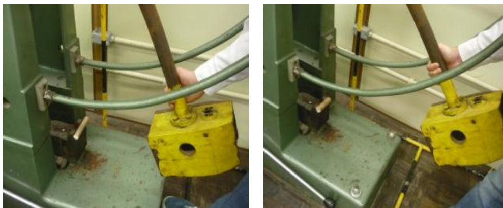
Figura 26 - Liberação do martelo no ensaio de impacto Fonte: Hoeflich et.al. (2011)
