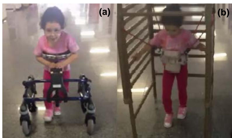
Figura 32 - Estrutura fixa do andador (a) e UTD com sustentação por elastômeros (b) Fonte: Autoria própria
