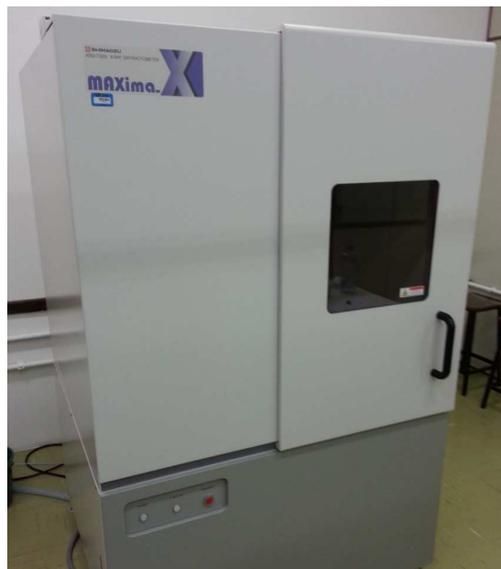
**Figura 14 – Difratorômetro de raio-X**
