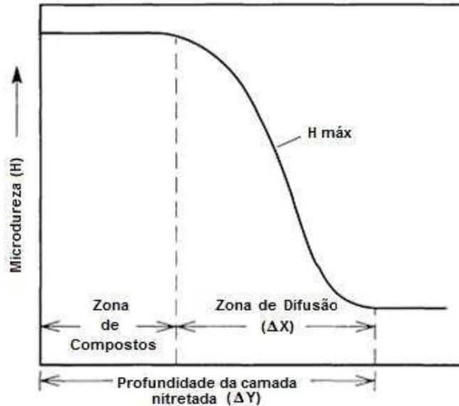
**Figura 6 - Perfil de dureza de um aço nitretado.**
