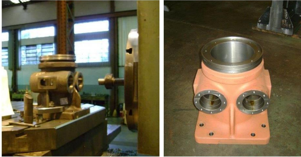
Figura 24 - Usinagem do Casco da Caixa de Giro (OFA0101)
