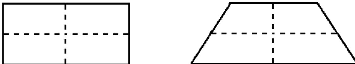
**Figura 4.18 – Deformação de um elemento pelo efeito *Hourglass***
