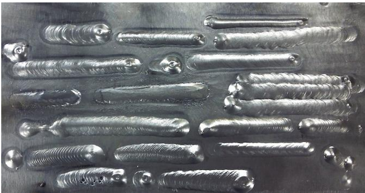
Figura 30 – Cordões soldados na fase de testes.
