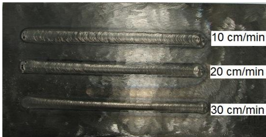
Figura 11 – Cordões depositados para análise metalográfica e morfológica.
