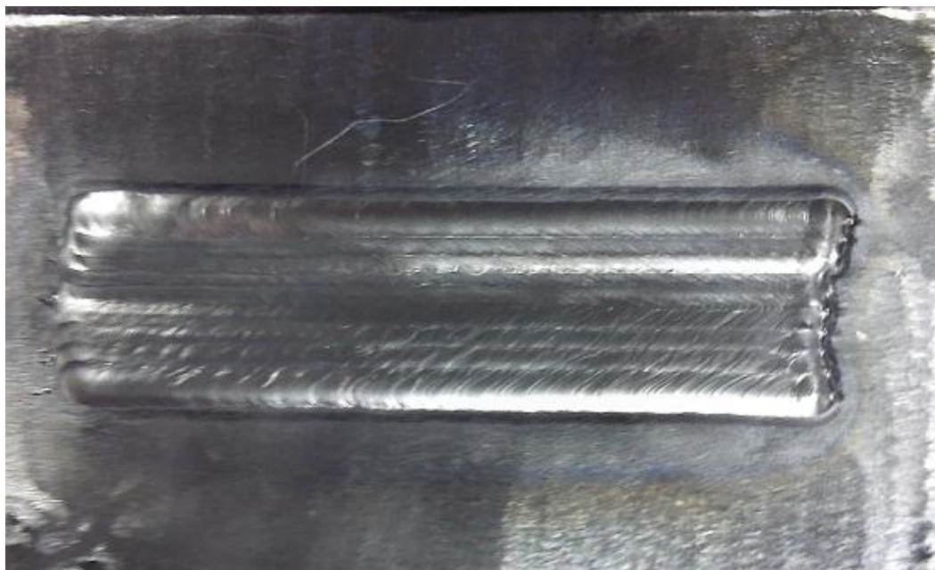
Figura 8 – Exemplo de um dos corpos de prova com o revestimento depositado.
