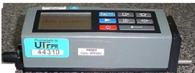
Figura 19 - Rugosímetro Instrutherm RP 200
