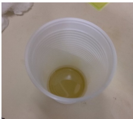
Figura 15 - Poliuretana derivada do óleo de mamona, após uso da bomba de vácuo
