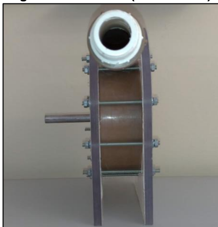
Figura 38 - Turbina (vista lateral).
