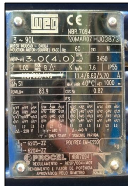
Figura 29 - Dados de Placa: Motor WEG 3.0 kW.
