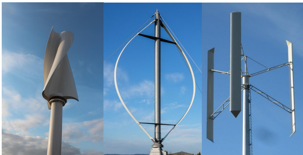
Figura 2: Turbinas eólicas com rotor de eixo vertical. Na sequência: a) Savonius, b) Darrieus e c) H-Darrieus
