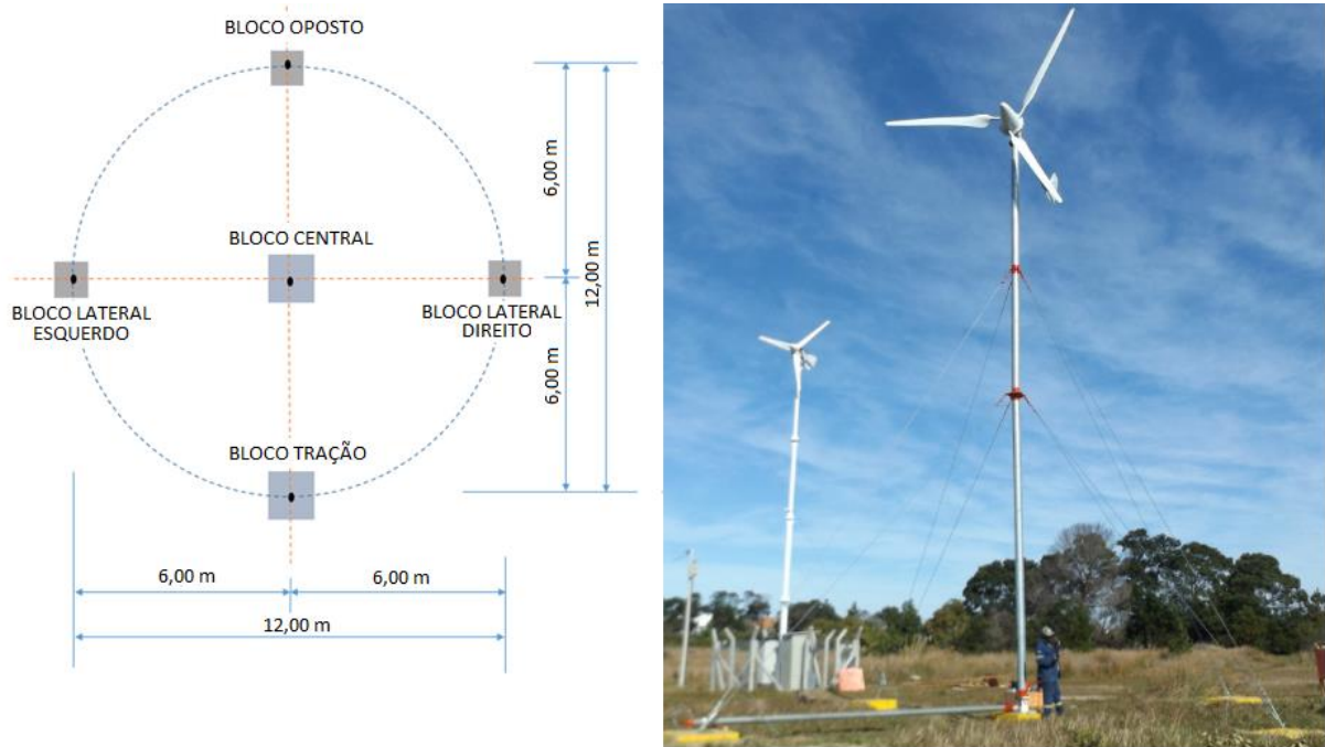
Figura 8: Gabarito de fundação e torre estaiada de 12 metros
