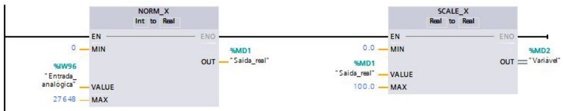
Figura 29: Teste das entradas analógicas do CLP Siemens S7-1200
