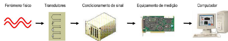
Figura 5: Diagrama funcional de um sistema de aquisição genérico.
