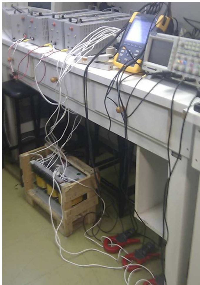
Figura 42 - Imagem do Transformador Encomendado na Bancada de Testes. Fonte: Autoria Própria.
