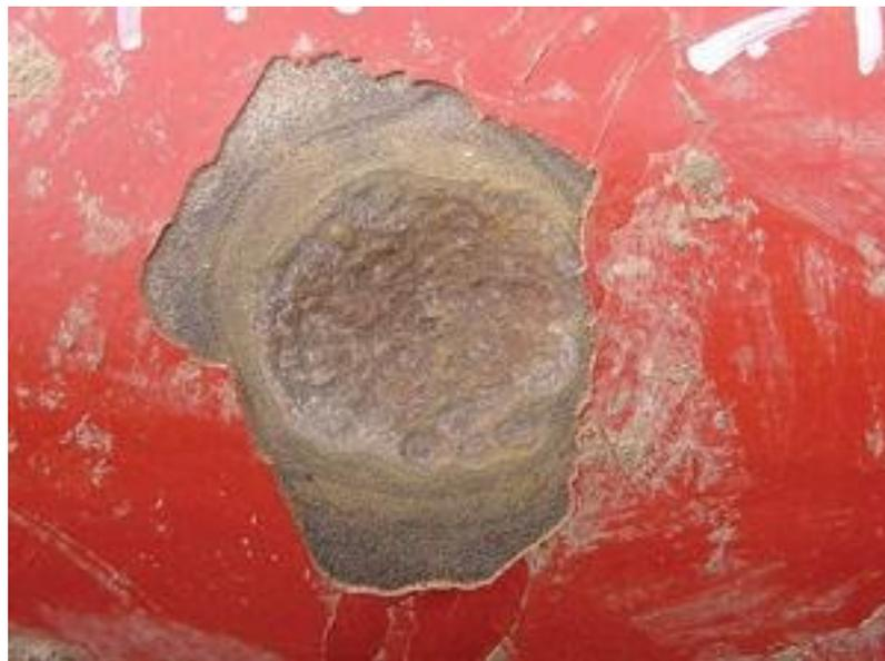
**Figura 1 - Corrosão do duto por corrente alternada.**
