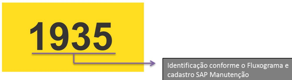
**Figura 11 – Modelo de placa de identificação de válvula em local próximo.**
