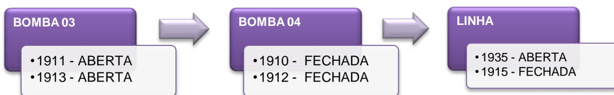
**Figura 22 – Fluxograma de alinhamento de válvulas de envase – Bomba 03.**
