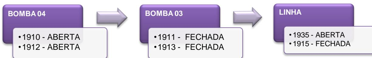
**Figura 23 – Fluxograma de alinhamento de válvulas de envase – Bomba 04.**
