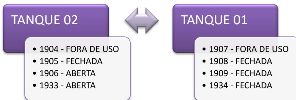
**Figura 20 – Fluxograma de alinhamento de válvulas de envase – Tanque 02.**
