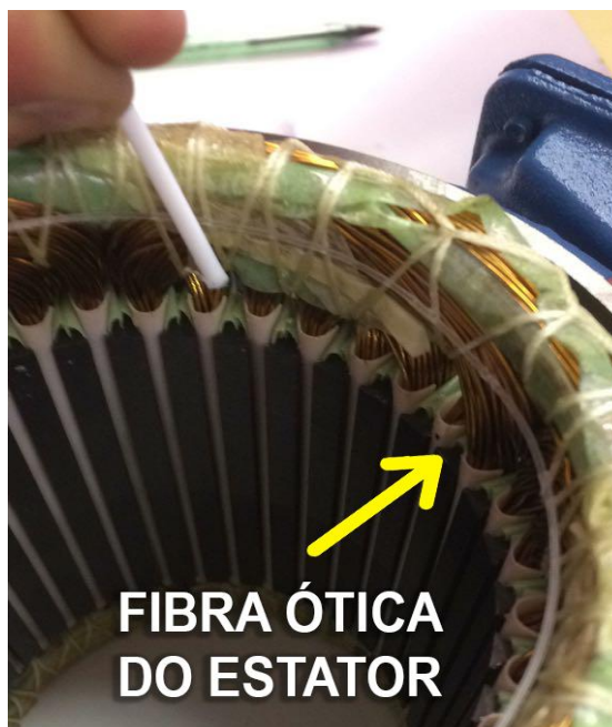
Figura 17: Colagem da fibra na cabeça de bobina do estator. Fonte: Autoria Própria
