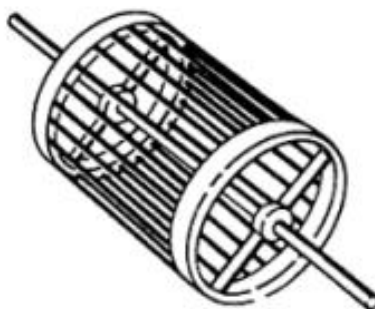
Figura 3: Barras e anéis de curto circuito de um rotor. Fonte: (EMATSU, 2008)
