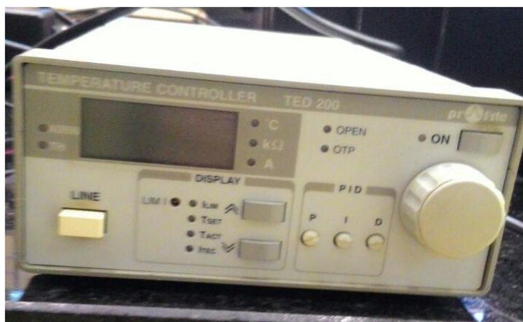
Figura 5 - Controlador de temperatura (TED 200) utilizado para os ensaios no Laboratório Foton.
