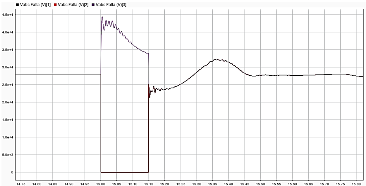
Figura 75 - Tensões de falta fase-fase-terra ( 0,00001 \Omega ) - GIDA Fonte: Simulink .
