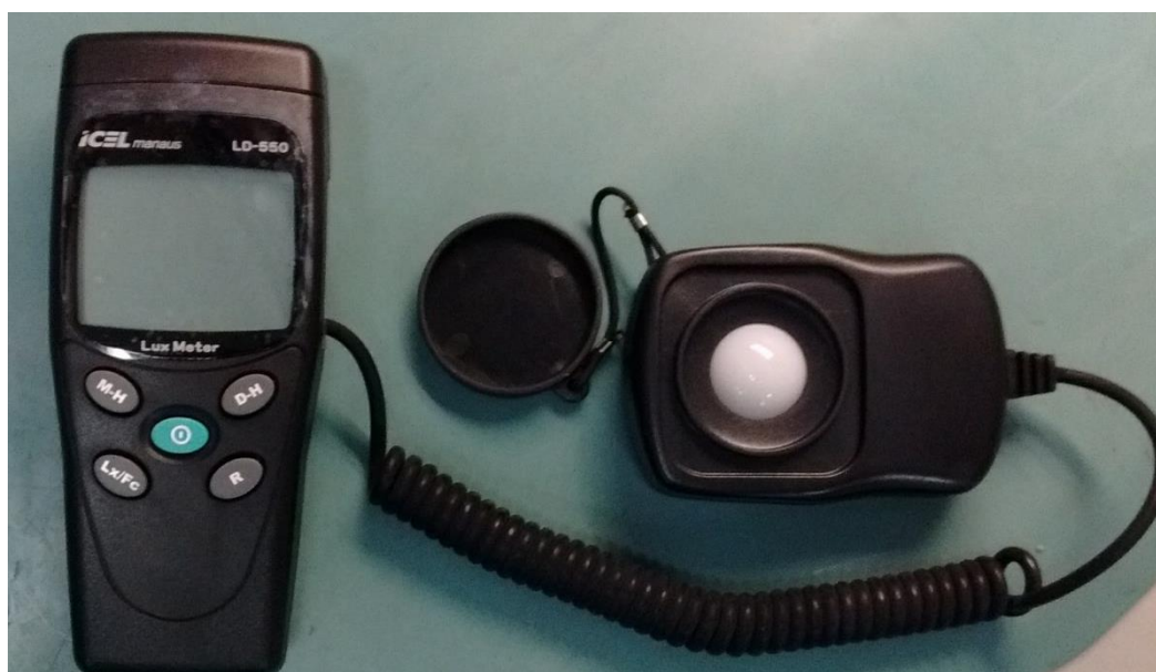
Figura 19 - Luxímetro utilizado nas medições, fabricante ICEL, modelo: LD-550. Fonte: Própria.
