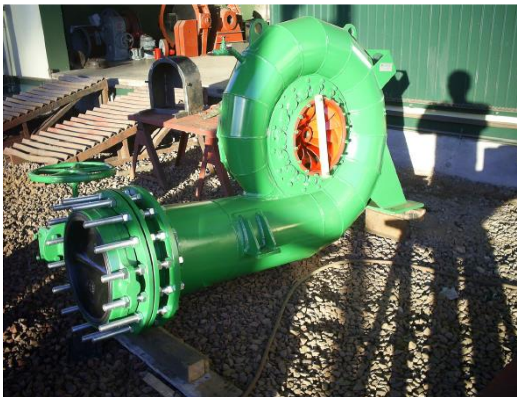
Figura 12 – Aspecto de uma turbina Francis para microcentrais Fonte: GOMES (2010).
