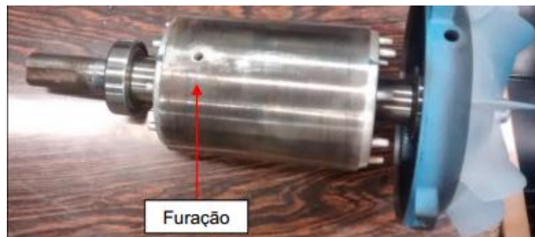
Figura 19: Rotor velho barra aberta Fonte: Autoria Própria.
