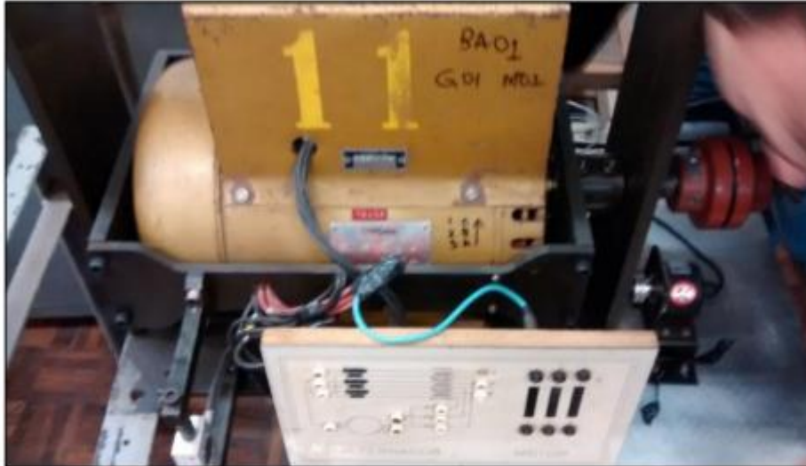
Figura 18: Gerador síncrono usado como carga para o sistema. Fonte: Autoria Própria.
