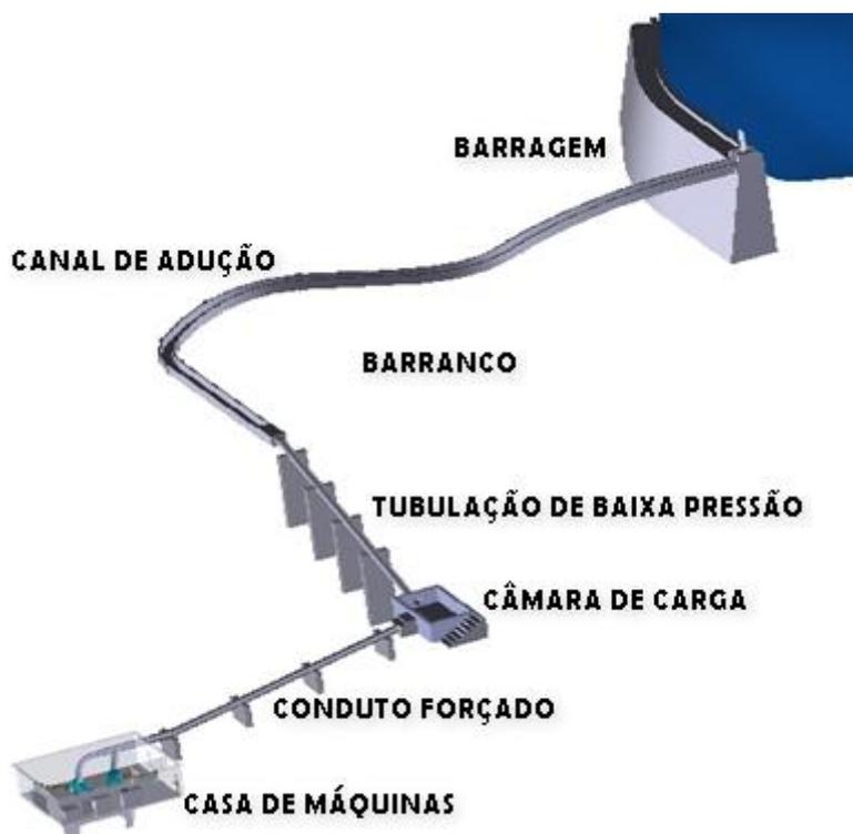
Figura 26 – 1ª localização da câmara de carga e conduto forçado já existente da MCH de Rio Branco do Sul
