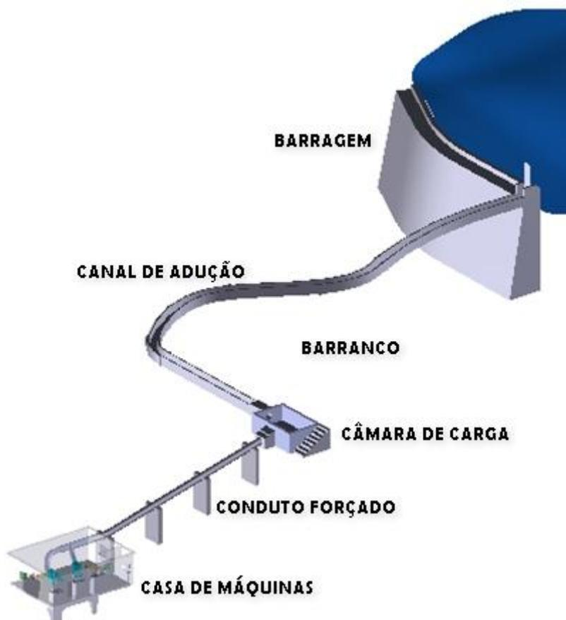
Figura 30 – 3ª localização da câmara de carga e conduto forçado da MCH
