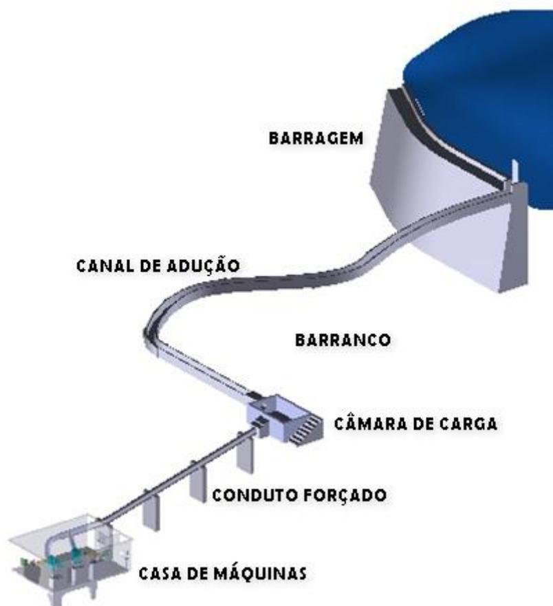
**Figura 28 – 2ª localização da câmara de carga e conduto forçado da MCH de Rio Branco do Sul**
