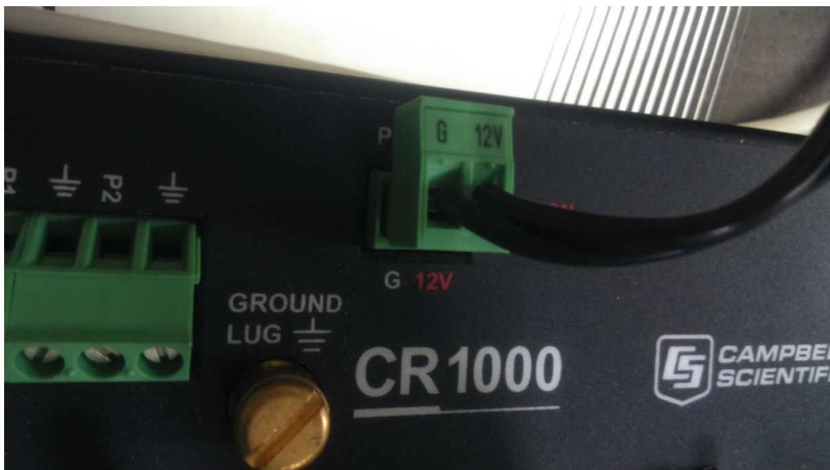
Figura 47 Borne de alimentação do Datalogger conectado com a tensão e polaridade corretos Fonte: Acervo da Autora
