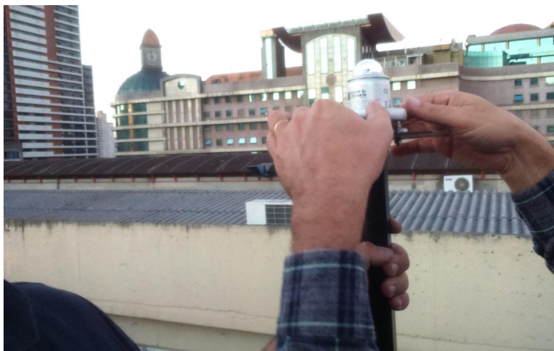
Figura 34 Fixação do piranômetro e nivelamento do mesmo Fonte: Acervo da Autora
