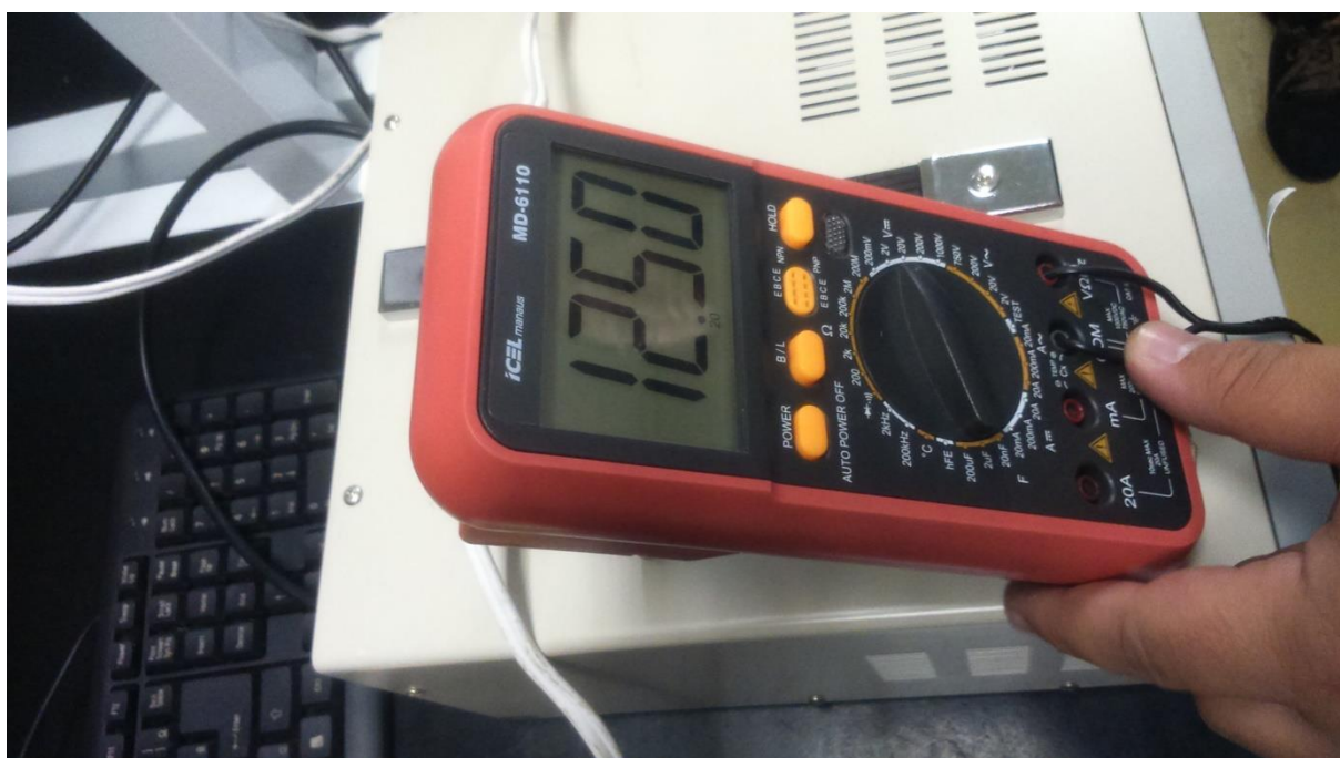
Figura 46 Verificação da tensão e polaridade da fonte de alimentação que será conectada ao Datalogger Fonte: Acervo da Autora
