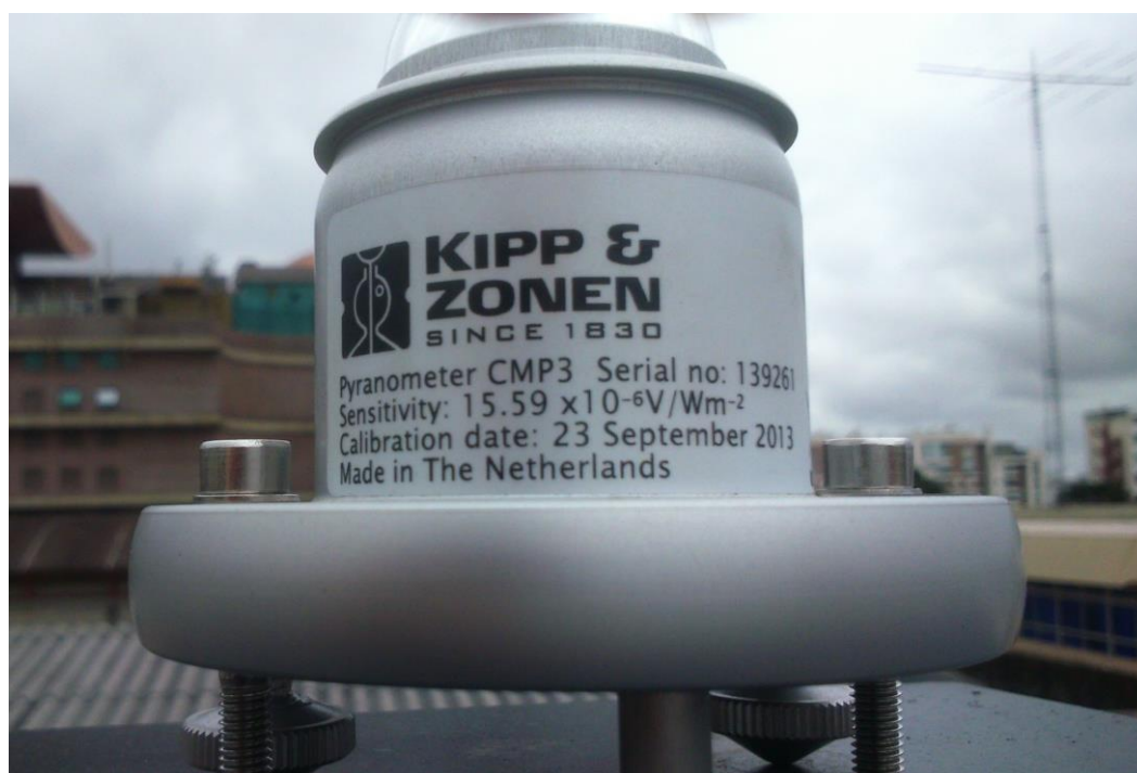
Figura 37 Piranômetro CMP 3, detalhe da sensibilidade do equipamento Fonte: Acervo da Autora
