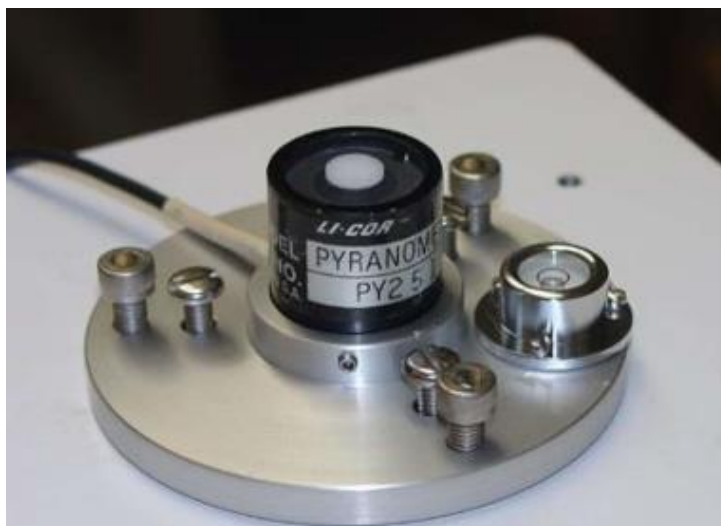
Figura 15 Termopilha do Piranômetro Fotovoltaico Fonte: PINHO e GALDINO, 2014
