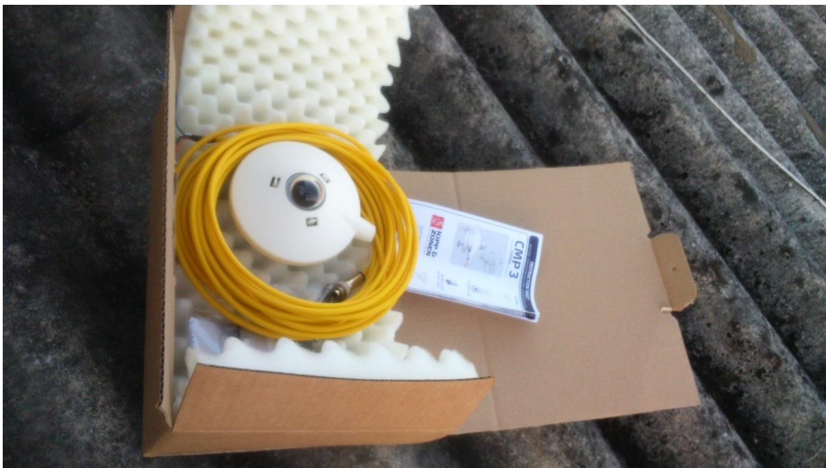
Figura 26 Abertura da caixa do Piranômetro Fonte: Acervo da Autora
