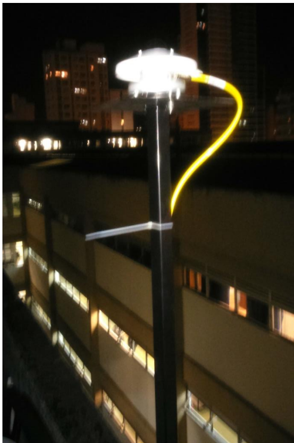
Figura 35 Cabo conectado ao Piranômetro Fonte: Acervo da Autora
