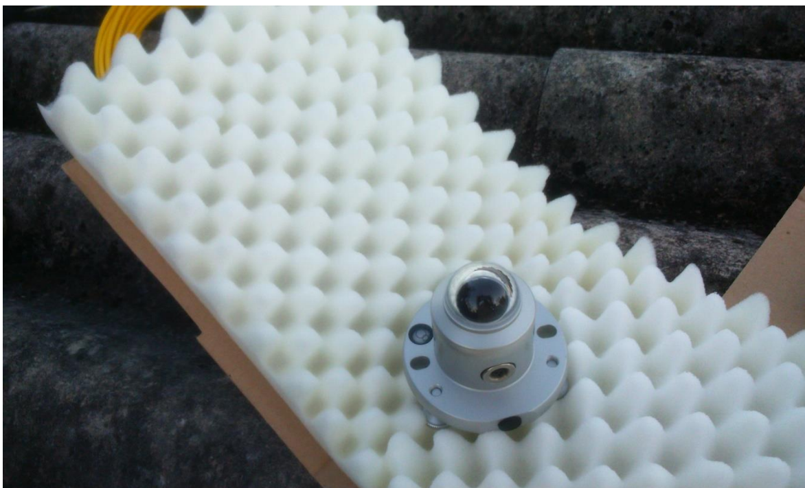
Figura 28 Piranômetro sem a tampa de proteção Fonte: Acervo da Autora
