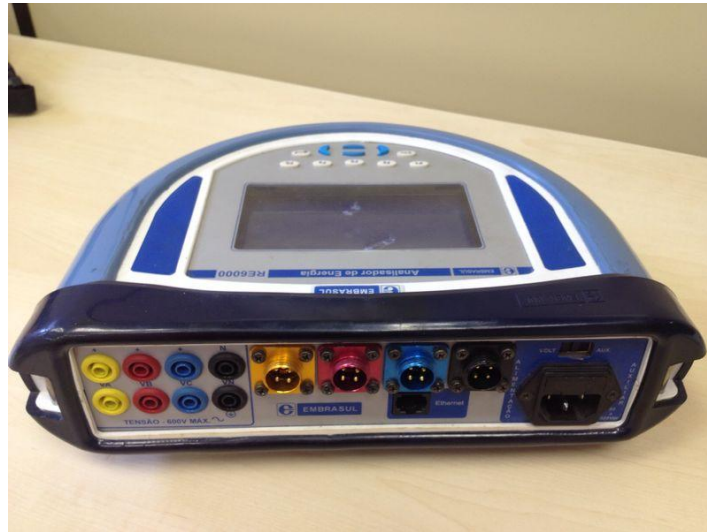
Figura 9 - Vista das conexões do analisador de energia Embrasul RE6000/N. Fonte: Autoria própria.
