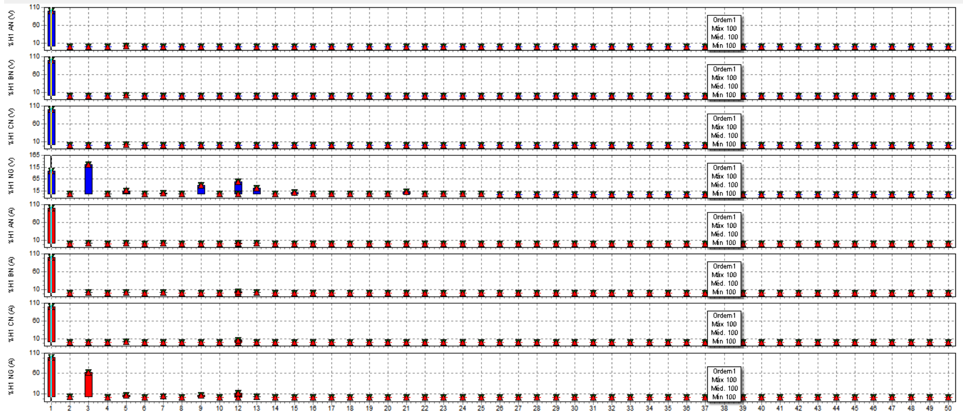
Figura 24 - Espectro de harmônicos totais de tensão e corrente do transformador de alimentação pelo Fluke 435 II. Fonte: Autoria própria.
