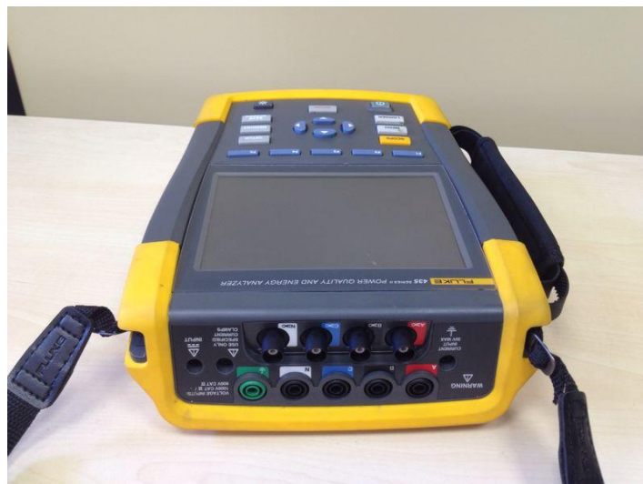
Figura 12 - Vista das conexões do analisador de energia Fluke. Fonte: Autoria própria.
