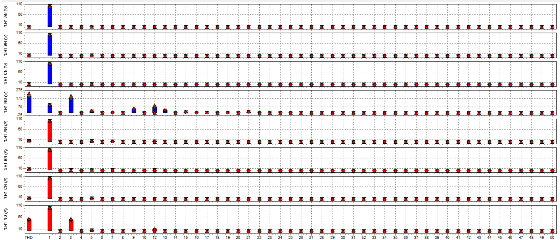
Figura 32 - Espectro de harmônicos individuais de tensão e corrente do chiller pelo Fluke 435 II. Fonte: Autoria própria.
