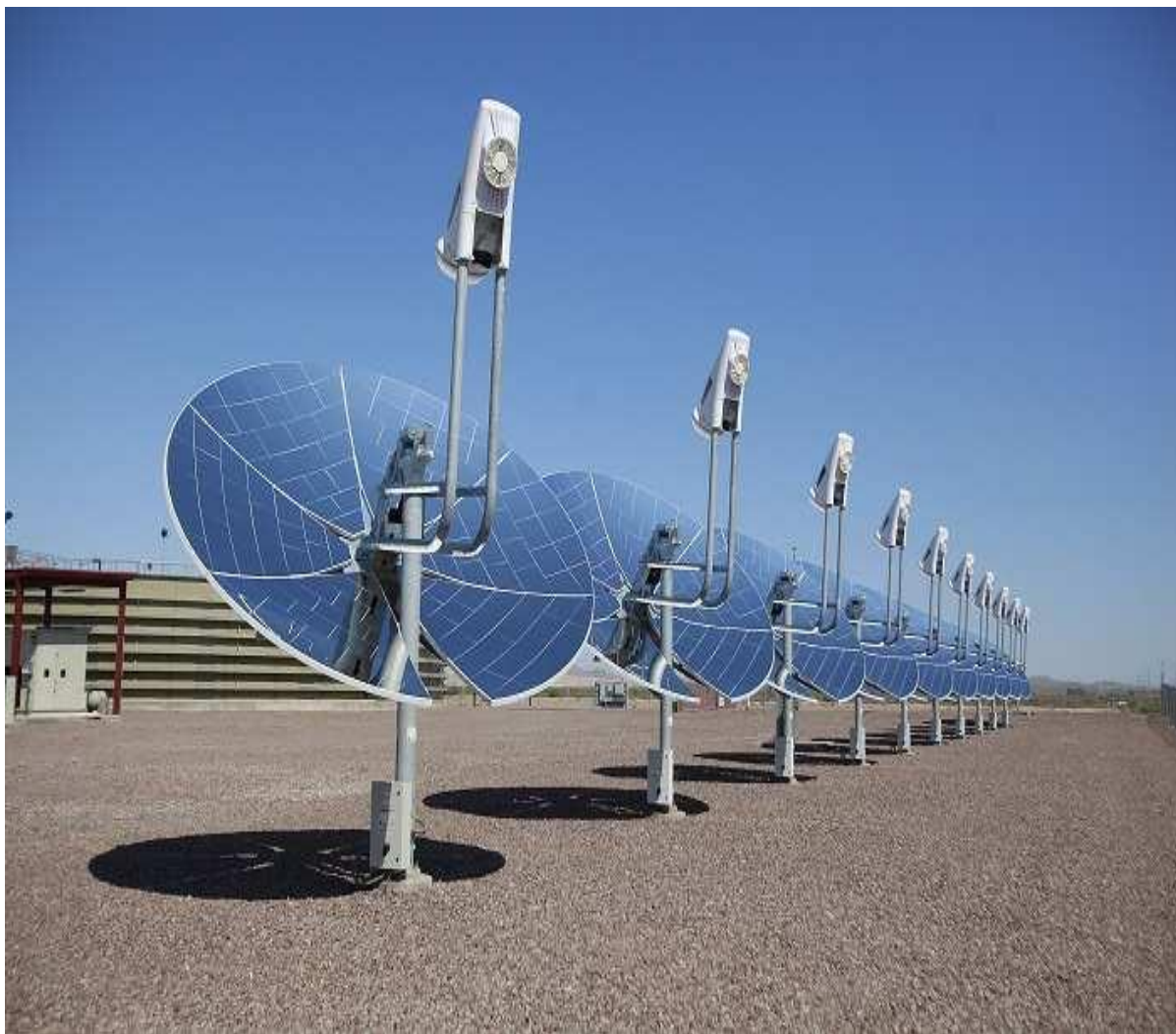
Figura 12 - Concentradores solares. Fonte: ALTERNATIVE ENERGY INFO, 2014.
