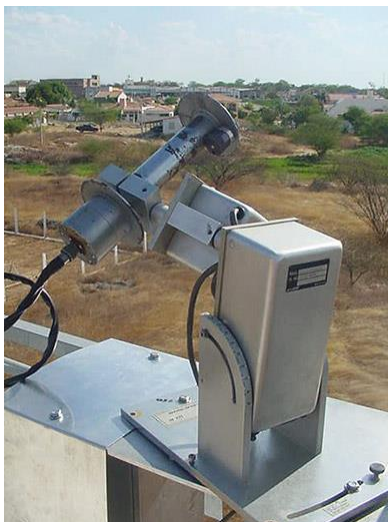
Figura 7 - Pireliômetro. Fonte: SONDA, INPE, 2002.
