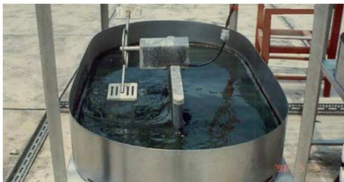
**Figura 10 - Biorreator tipo *raceway pond* em pequena escala utilizado em estudo na Malásia (HABIB & PARVIN, 2008).**
