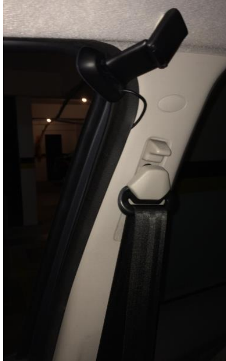
Figura 19. Posicionamento correto da câmera lateral direita
