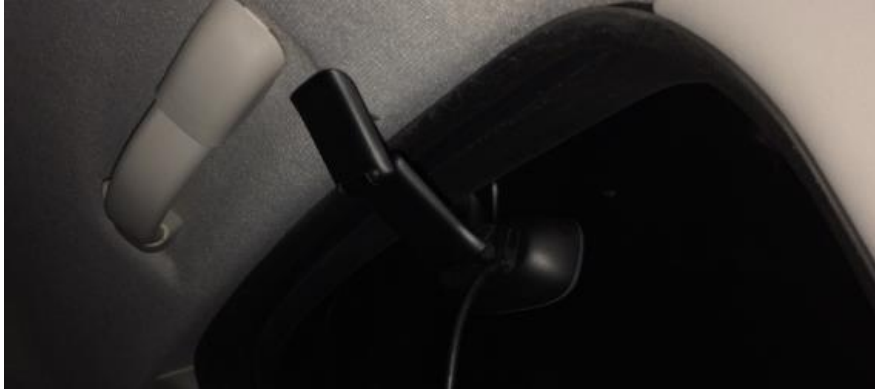
Figura 17. Posicionamento da câmera lateral
