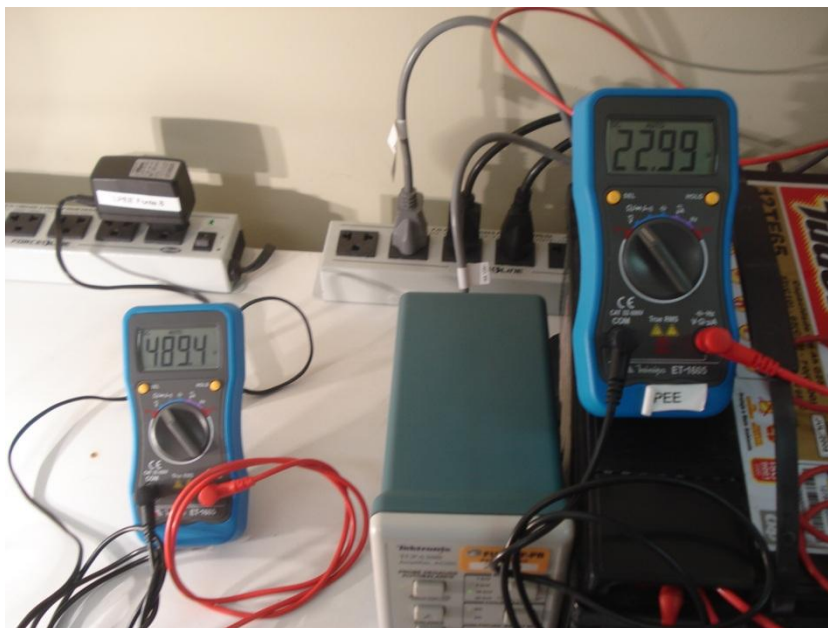
Figura 52 - Protótipo em Funcionamento, com detalhe no ganho estático obtido.
