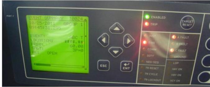
Figura 41 - Painel frontal após atuação da função 51
