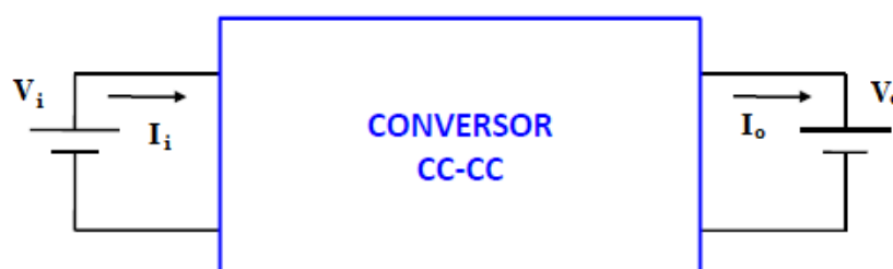
Figura 21 - Representação simplificada de um conversor CC-CC.
