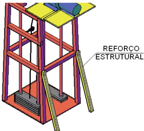
**Figura 5.15 – Detalhe do reforço estrutural.**
