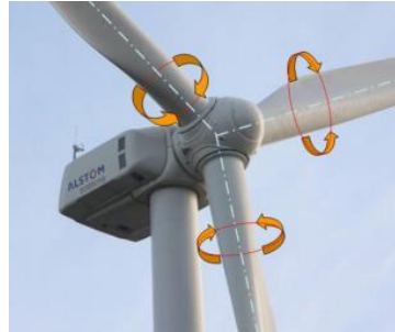
Figura 30 - Movimento realizado pelo Controle de Passo.
