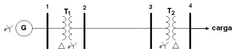
Figura 3 – Diagrama unifilar de um sistema elétrico
