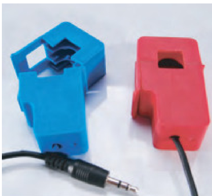
Figura16 – Sensor de Corrente não intrusivo SCT013. Fonte: BEIJING (2015).
