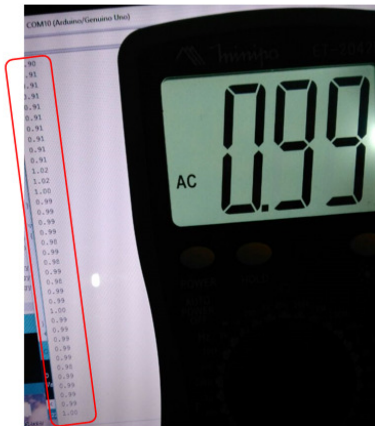
Figura24–Verificação e validação dos valores de corrente (Arduino e multímetro). Fonte: Autoria Própria.
