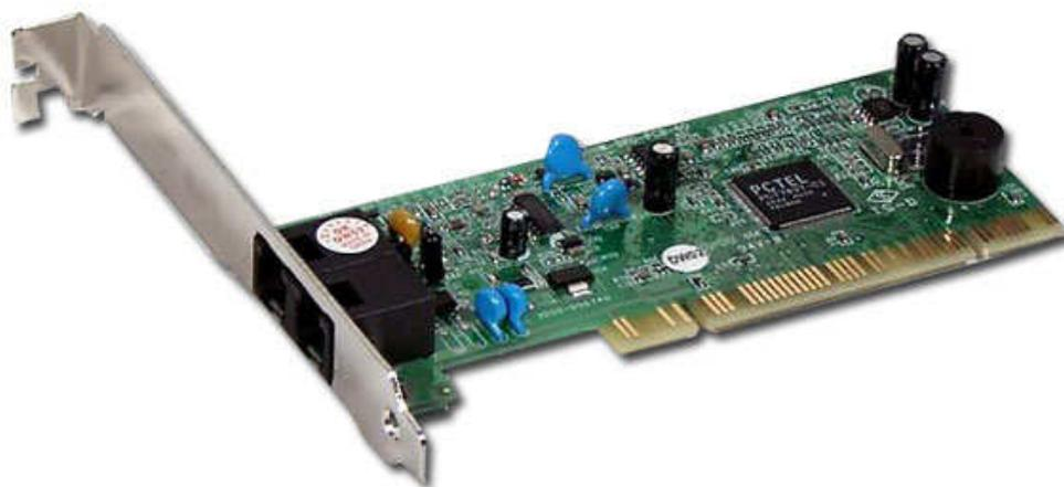
**Figura 5 - Modem interno PCI.**
